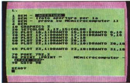
Il disegno sullo schermo dell'Atari nella foto di apertura è ottenuto con il programma qui sopra; il modo grafico utilizzato è il 3.
