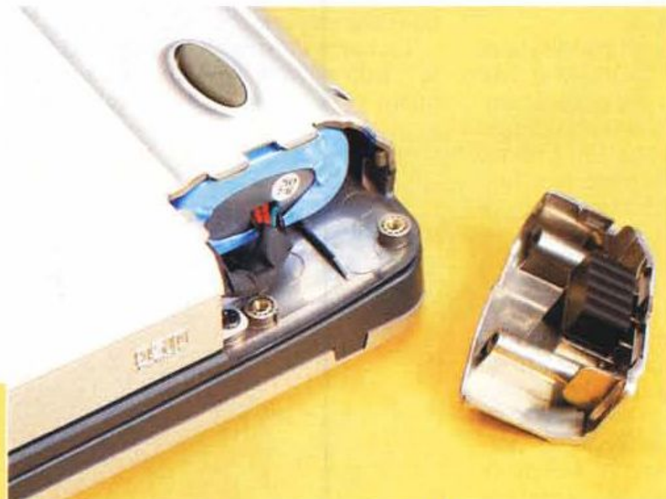
La grossa batteria utilizzata dal portatile: assicura una autonomia di circa due ore e mezza a pieno regime.
