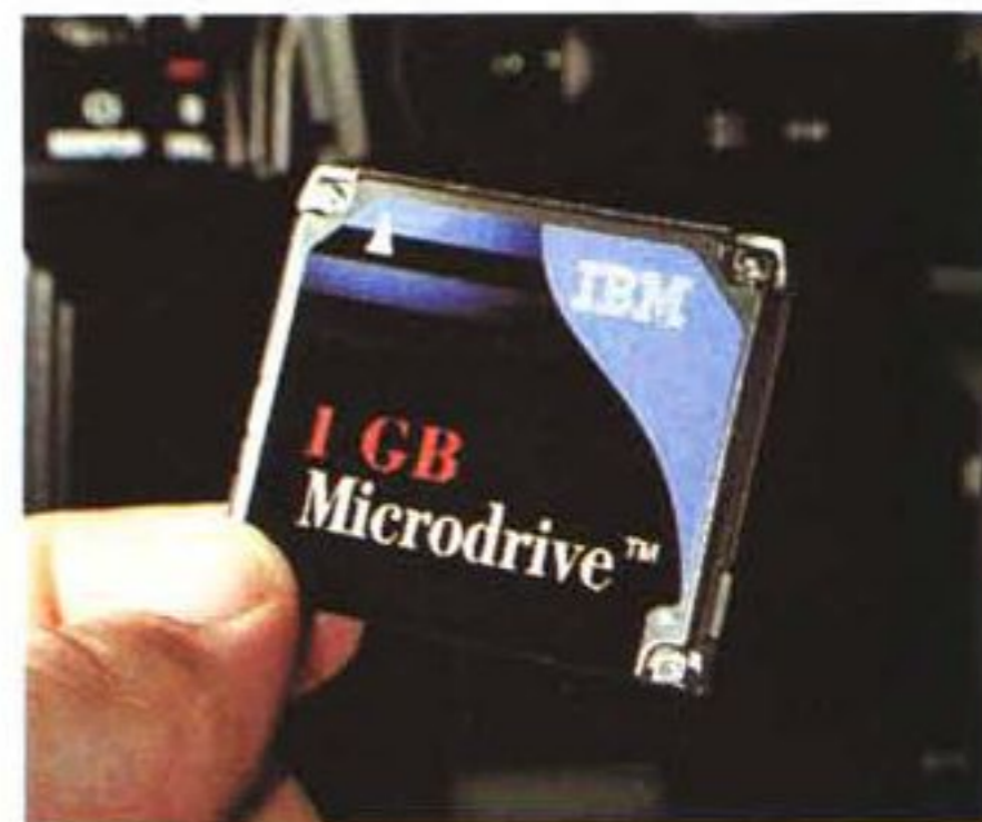
Gran parte delle fotocamere dotate di alloggiamenti per memorie in standard CompactFlash possono utilizzare il Microdrive IBM: un microscopico hard disk da 1GB.
