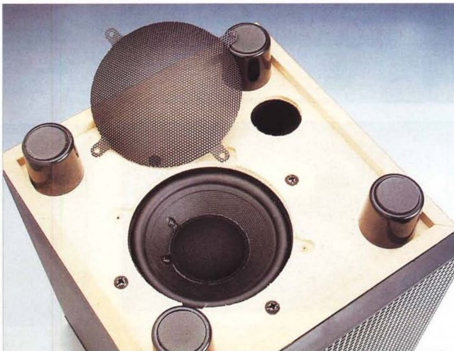
Il mobile del sub è in MDF, il materiale ideale per la costruzione di casse acustiche, e l'altoparlante impiegato è un woofer da 10 cm con cono in carta e membrana in gomma. Il foro con corrispondente condotto di accordo presente sul fondo del mobile indica che si tratta di un sistema reflex.
