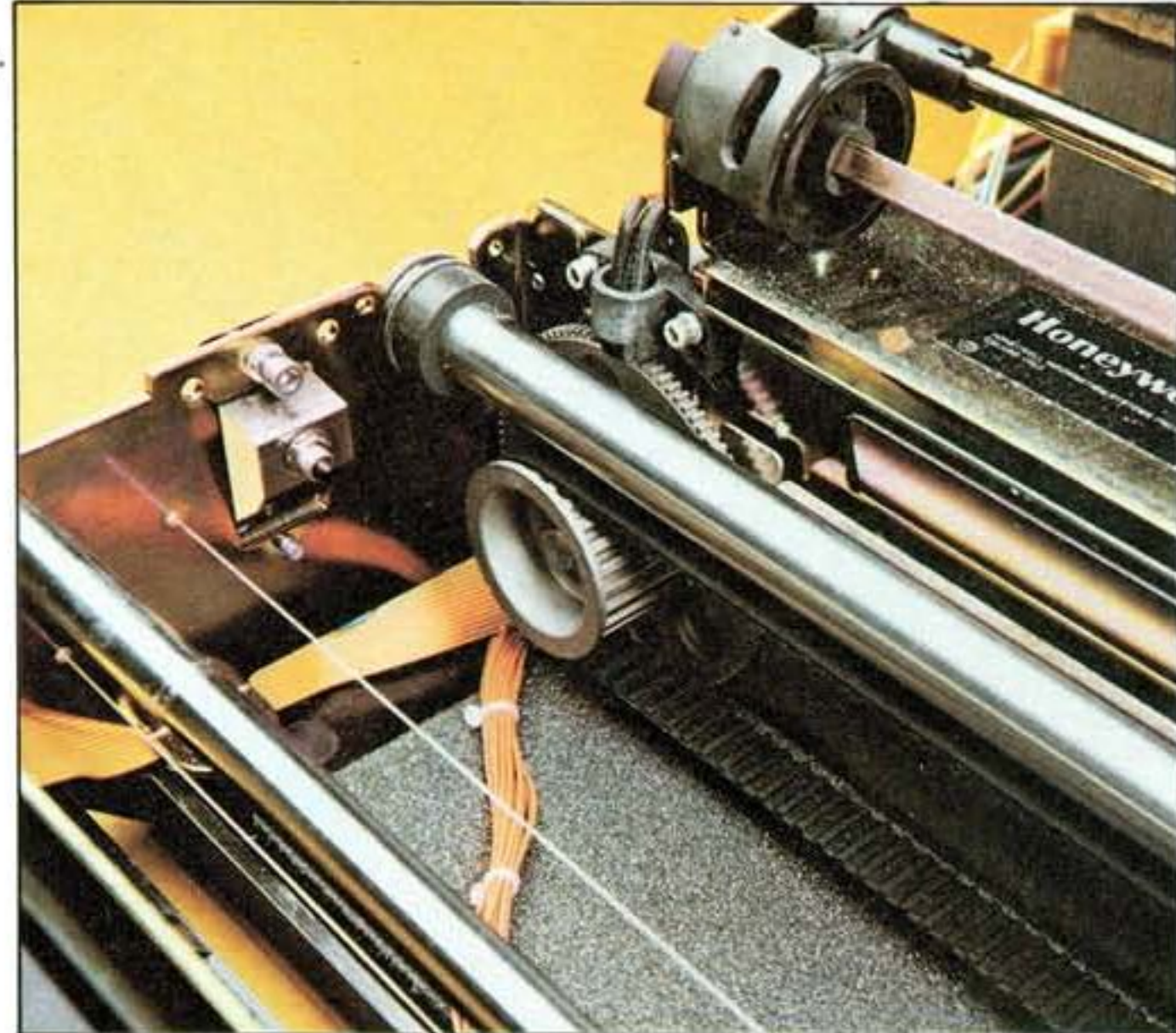
La trasmissione del movimento dal motore alla testa stampante avviene per mezzo di una robusta cinghia dentata di gomma.
