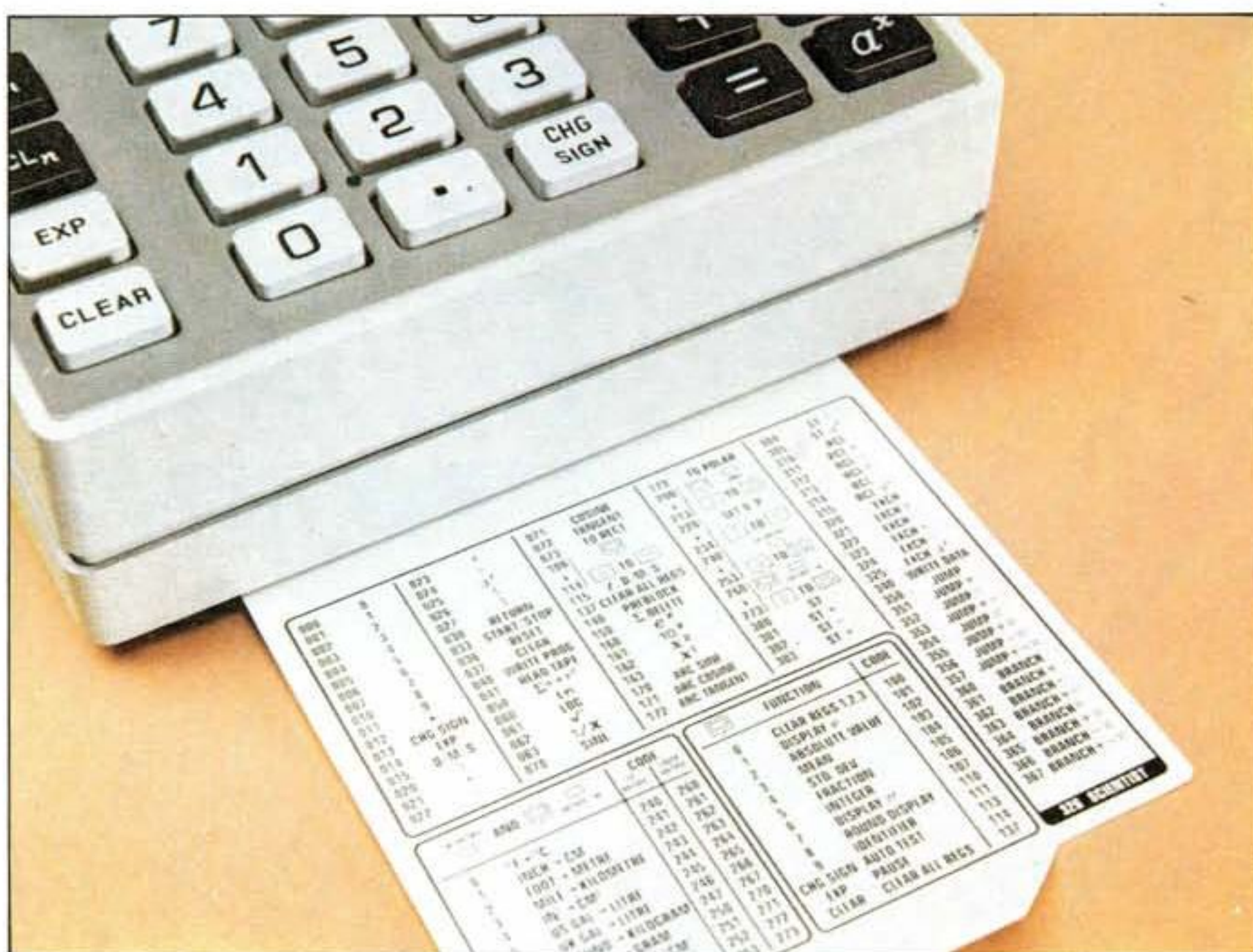
Considerato che i codici delle istruzioni, che compaiono in modo "LOAD", sono in "ottale", risulta molto utile avere sotto gli occhi una tabellina contenente la codifica di ogni istruzione. Ancora meglio se questa tabellina è a portata di mano, usando la calcolatrice, senza dover consultare il manuale.
