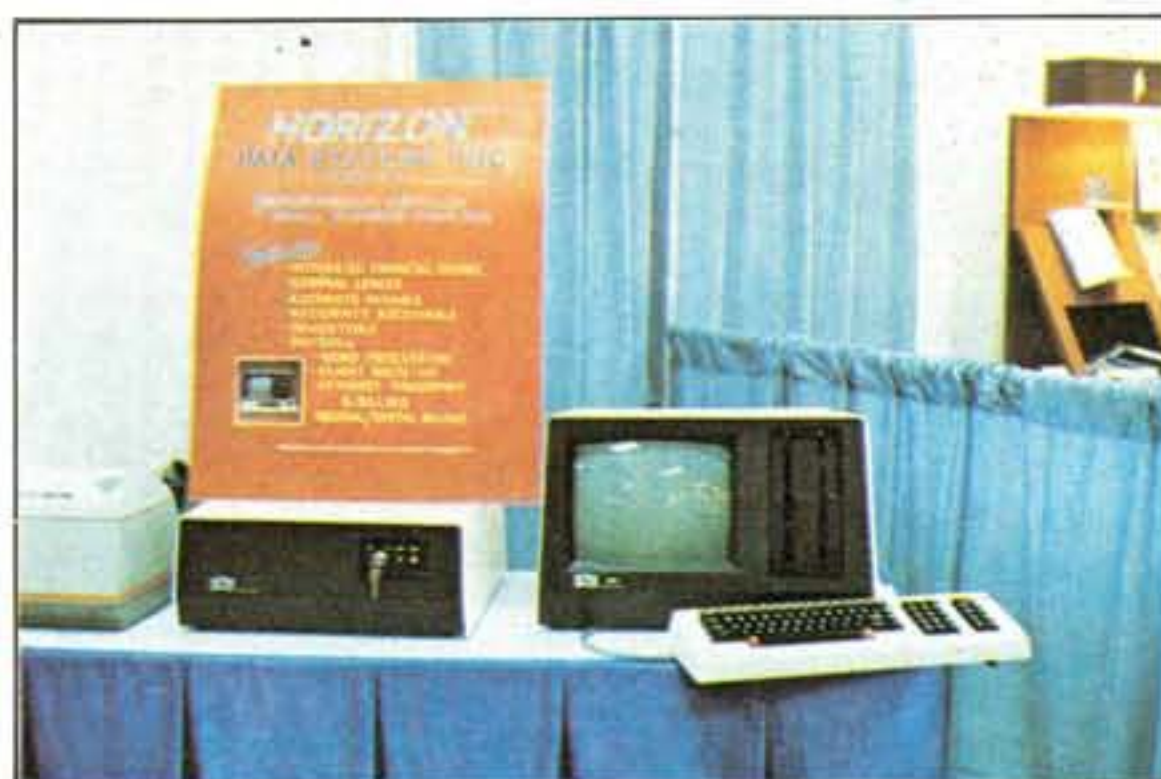
Ecco l'SDS, sembra una bella macchina: usa il microprocessore 6800 della Motorola e comprende due floppy da 8" doppia faccia doppia densità, da 1.2 megabyte ciascuno. Dovrebbe essere disponibile anche un hard disk da 23 megabyte.
