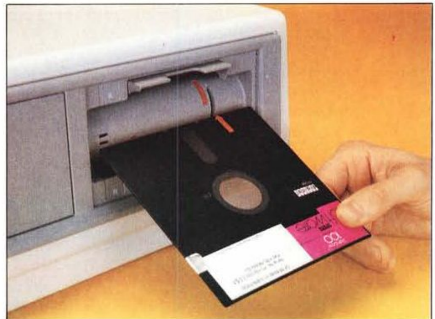
L'inserimento dei dischetti nei drive è "guidato" dalle frecce rosse presenti sia sulla porta dei drive che sui dischetti stessi. Una insolita particolarità del Rainbow 100 è che i floppy, soft sectored, sono già formattati.
