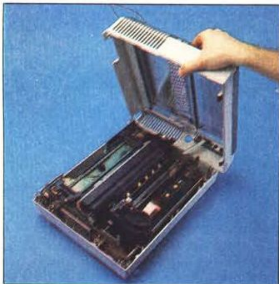
Da sinistra a destra, tre fasi dello smontaggio dello chassis della carrozzeria. La foto al centro, in particolare, illustra bene la struttura "a guscio" della carrozzeria. Il cavetto volante che si vede nella foto a destra va al pannello di controllo.
