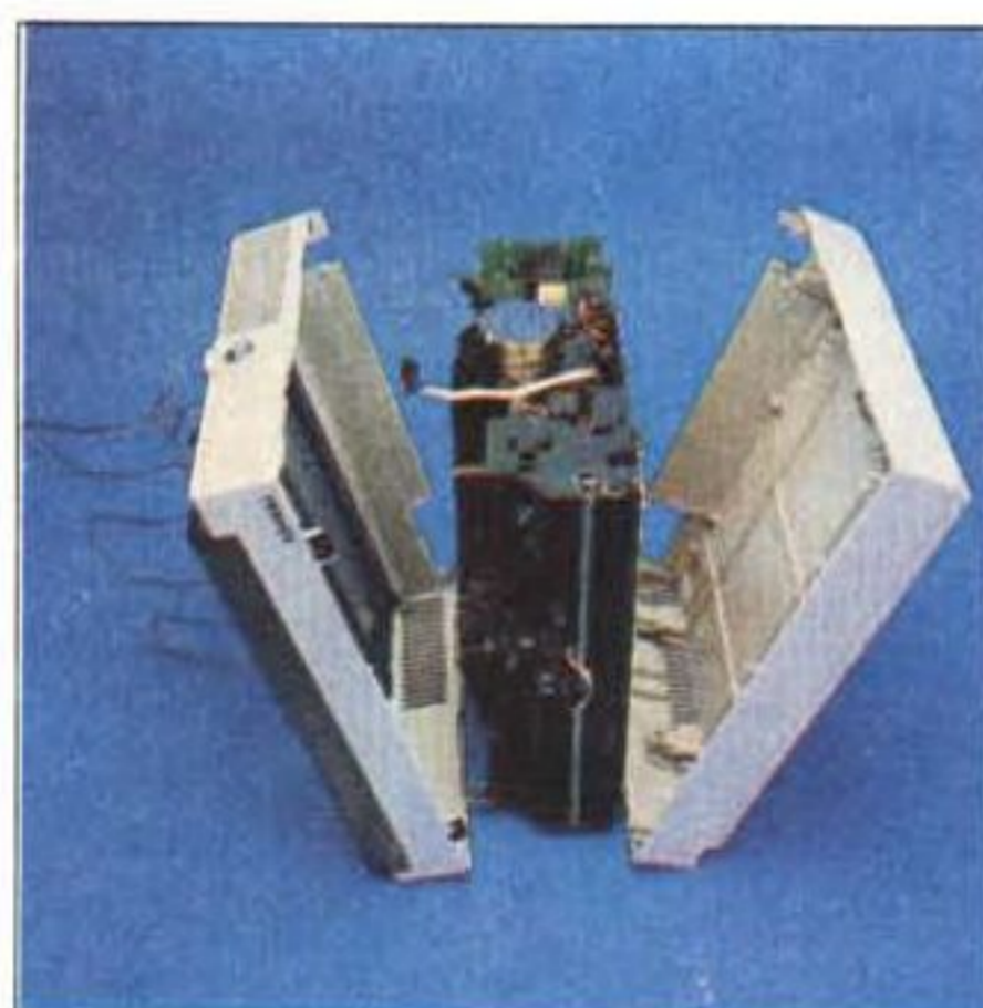
Da sinistra a destra, tre fasi dello smontaggio dello chassis della carrozzeria. La foto al centro, in particolare, illustra bene la struttura "a guscio" della carrozzeria. Il cavetto volante che si vede nella foto a destra va al pannello di controllo.
