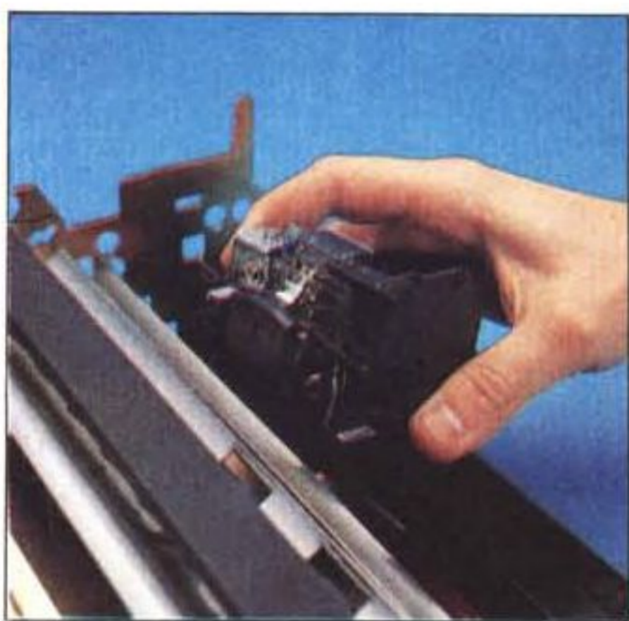
Due viste della testa di stampa a getto d'inchiostro. L'immagine di sinistra mostra la compattezza del dispositivo: si vede la parte anteriore della testa, solitamente posta contro la carta. A destra un particolare dei nove condotti piezoelettrici terminanti con gli ugelli da cui fuoriescono le microgocce. Entrambe le foto sono state realizzate smontando quasi completamente il piano di stampa ed estraendo la testa dalle barre sulle quali scorre.
