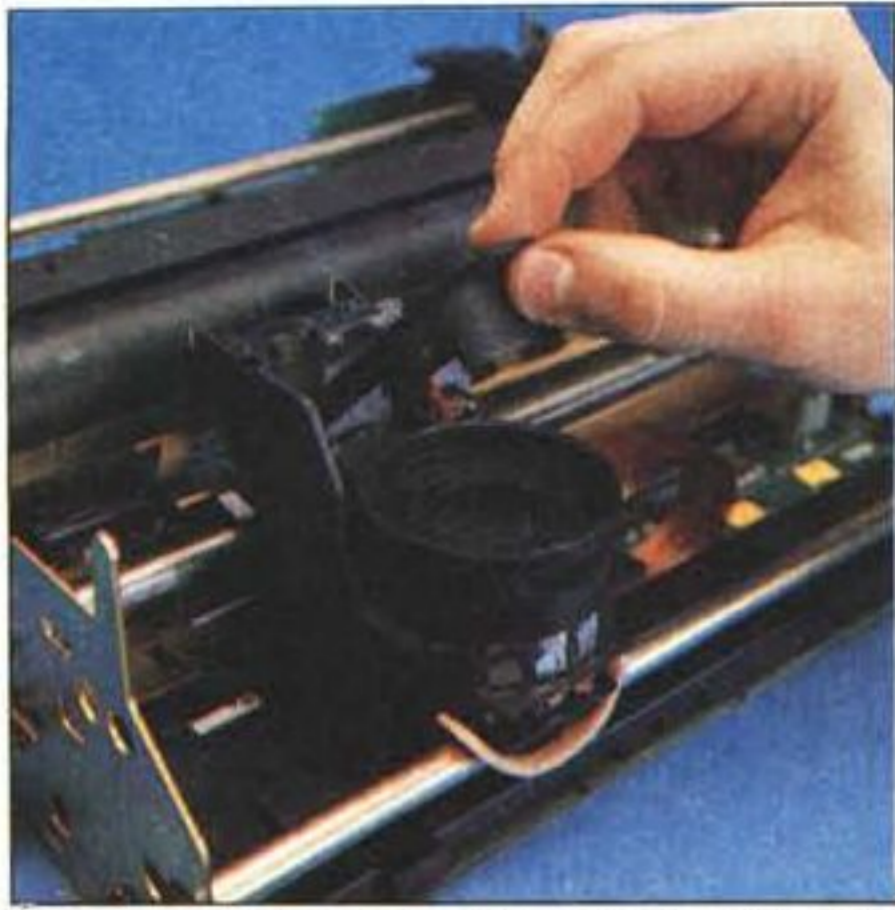
Due momenti dell'estrazione del contenitore dell'inchiostro. Basta alzare il pressore a molla e svitare il piccolo cilindro dal suo attacco a baionetta. Nella foto di destra sono ben visibili i contatti elettrici del sensore di livello dell'inchiostro.
