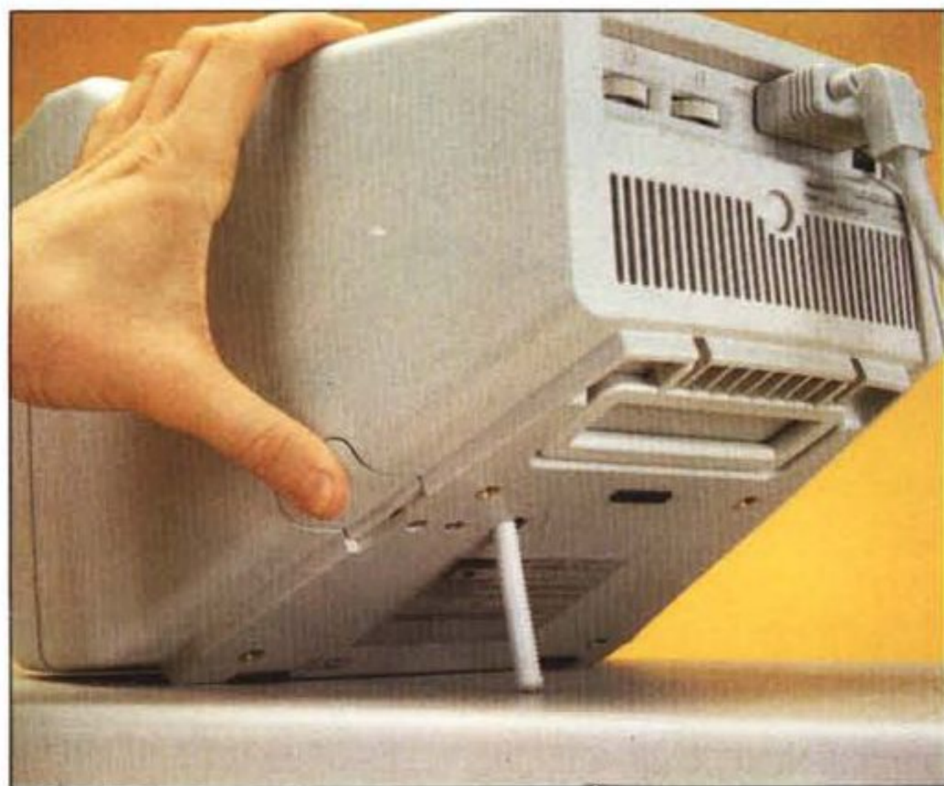
Foto a sinistra - Per orientare verticalmente il monitor la casa costruttrice ha escogitato un sistema semplice e sicuro; una specie di asticciola che può essere "fermata" in una qualunque posizione e mossa servendosi del pulsante laterale. Sul retro del monitor si notino anche i controlli di luminosità e contrasto.
