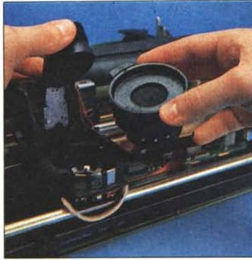
Due momenti dell'estrazione del contenitore dell'inchiostro. Basta alzare il pressore a molla e svitare il piccolo cilindro dal suo attacco a baionetta. Nella foto di destra sono ben visibili i contatti elettrici del sensore di livello dell'inchiostro.
