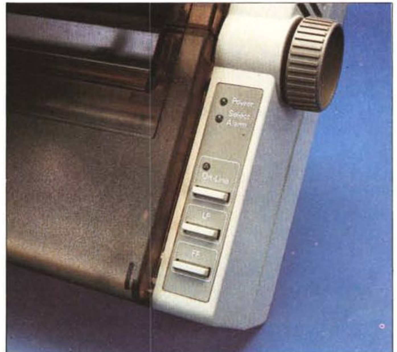
Sopra, la stampante con le due sezioni del coperchio aperte; a destra un particolare del pannello di controllo con la manopola di avanzamento carta.
