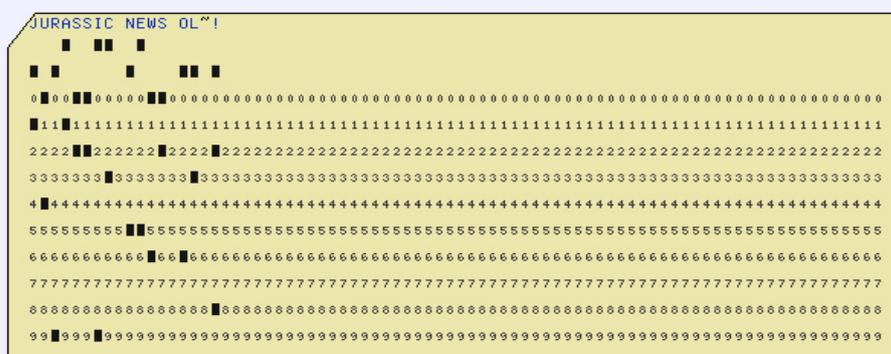
va a perforare la scheda nei punti giusti per definire il codice del dato digitale da elaborare (vedi figura di apertura). Si posizionava il pacco di schede nel contenitore in alto a sinistra e una alla volta la macchina le faceva scorrere davanti alla tastiera e le posizionava poi nell'alloggiamento di destra, pronte ad essere prese in blocco e inserite nel lettore ottico del calcolatore.
