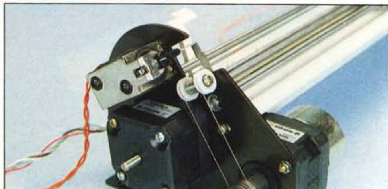
Particolari del sistema di trasferimento. Notare i due pressori (quello di destra è regolabile a seconda della dimensione del foglio) e l'elettromagnete che alza e abbassa la penna.
