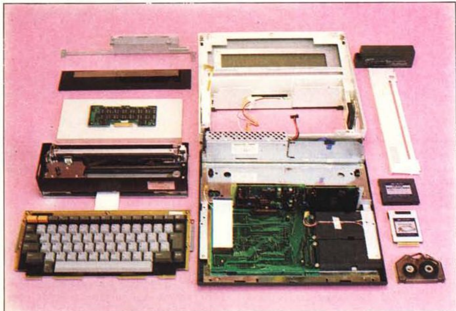
L'esplosione del PC-5000 ne mostra la costruzione estremamente raffinata.
