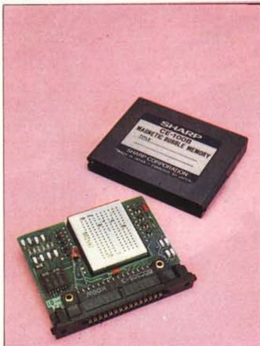
Il PC-5000 è dotato di una primizia tecnologica, un Bubble Memory Drive con cartuccia rimovibile, capace di 132 Kbyte. Si usa come fosse una cassetta, ma i tempi di accesso sono inferiori a quelli del disco.
