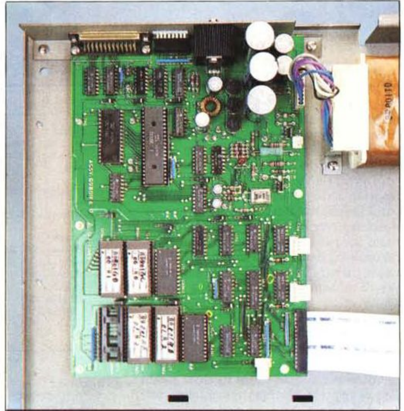
Il plotter aperto: notare la pulizia della costruzione. Il "ponte" con la meccanica di stampa, e la scheda contenente tutta l'elettronica.
