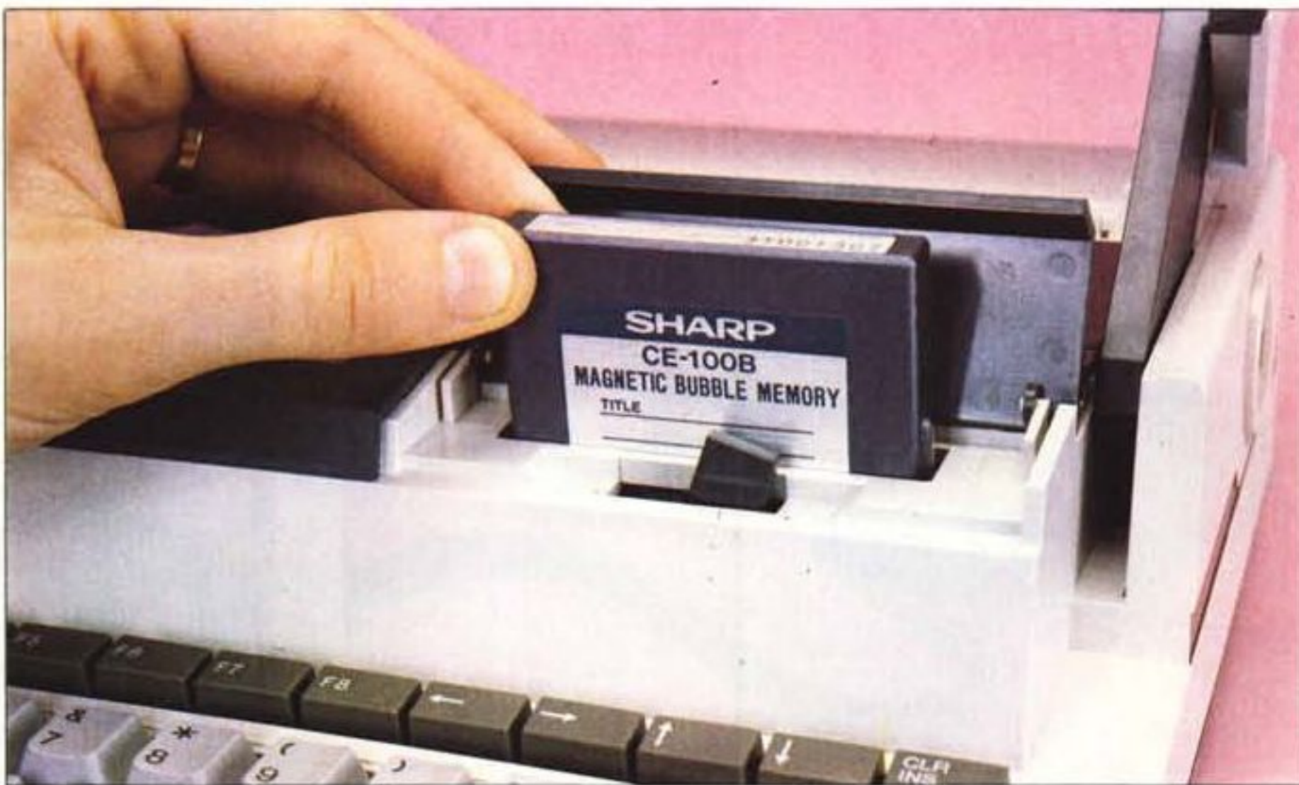
Il PC-5000 è dotato di una primizia tecnologica, un Bubble Memory Drive con cartuccia rimovibile, capace di 132 Kbyte. Si usa come fosse una cassetta, ma i tempi di accesso sono inferiori a quelli del disco.
