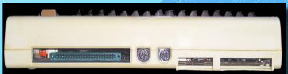
6 - Il retro del Vic 20 dove sono presenti da sinistra la porta per le cartucce, la porta audio/video, la porta I/O, lo slot per il registratore Datassette e la User Port programmabile.
