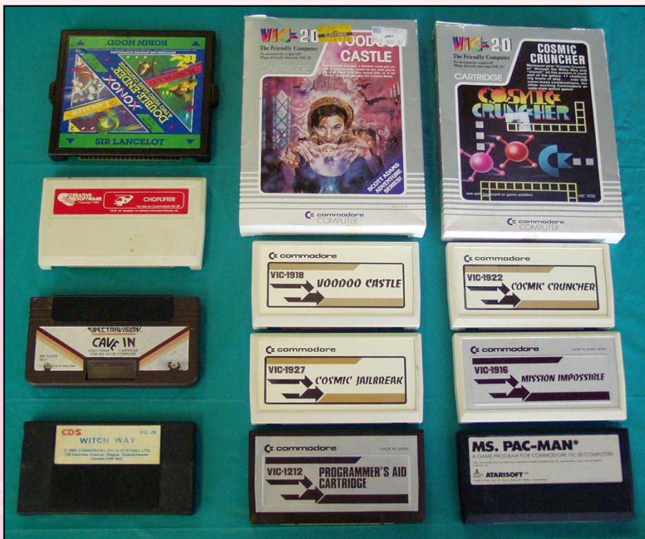
23 - Le cartucce Rom venivano distribuite in diversi formati estetici o funzionali. Da notare in alto a sinistra la cartuccia a doppio ingresso contenente due giochi in un unico modulo.
