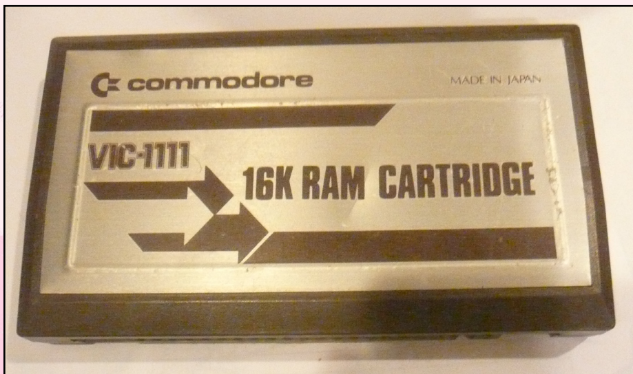
19 - La VIC 1111, ovvero la cartuccia di espansione RAM da 16 Kbyte.
