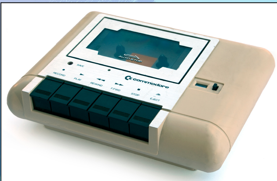
11 - L'omnipresente C2N-1530, registratore a cassette discretamente affidabile, ma compagno inseparabile del Vic20.
