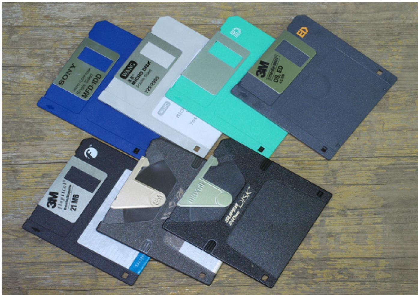
di mantenere una densità di dati molto maggiore e di ottenere una capacità di ben 21 Mbytes. Di particolare interesse il fatto che i drives floptical potevano leggere e scrivere anche i normali floppy HD, così come anche il floptical poteva, in caso di necessità, essere usato nei normali drives floppy. In entrambi questi casi la capacità era limitata, naturalmente, a quella propria del floppy.
