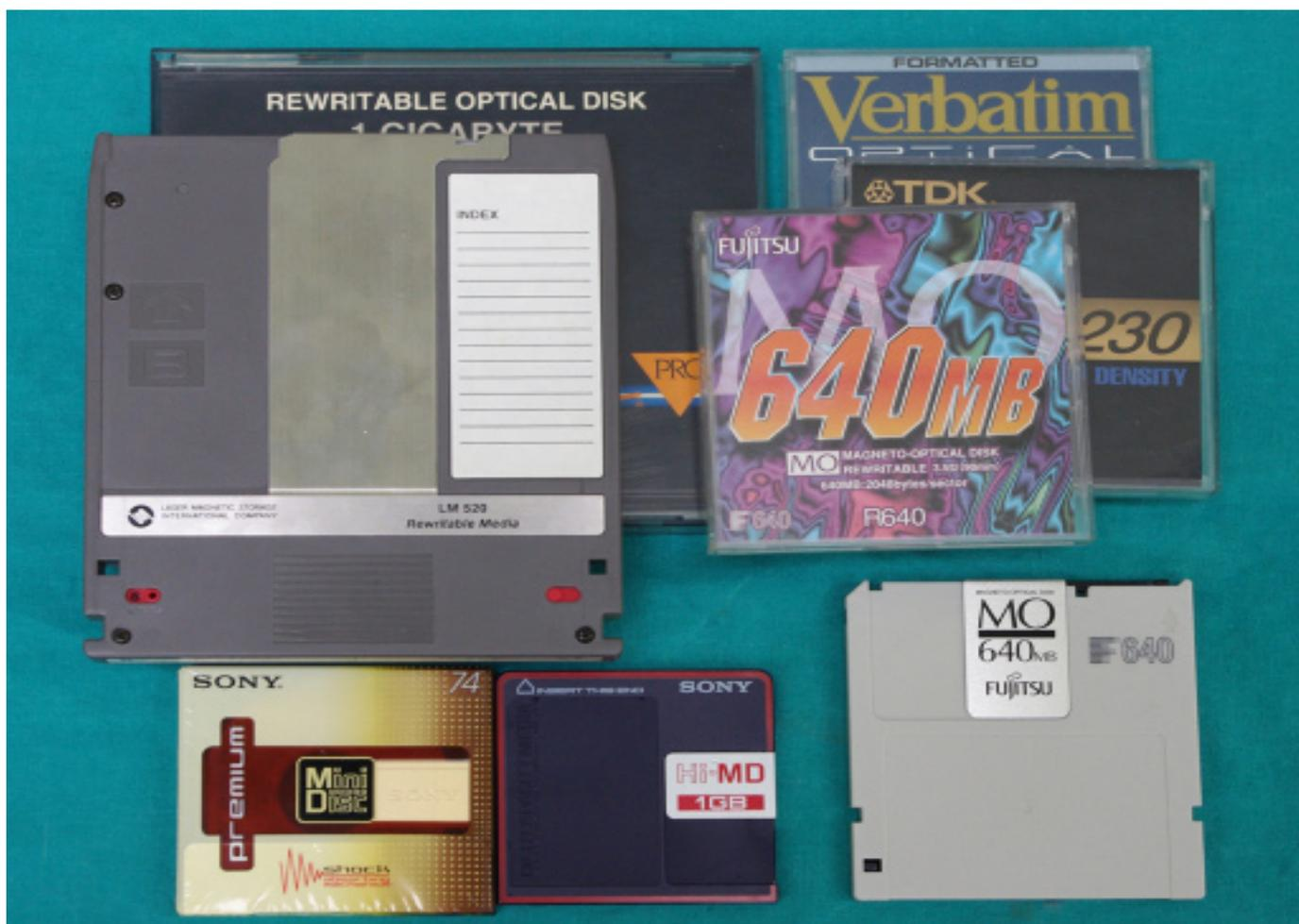
*Figura 8* Alcuni apparati MD recenti, tuttavia, sono equipaggiati di una porta USB e possono registrare anche dati. Il successivo modello Hi-MD dichiara anzi esplicitamente la sua capacità di 1 Gbyte, un ottimo dato in un ingombro ridottissimo in confronto agli altri magneto-ottici. L'uso del Mini Disc come supporto di memoria è stato, tuttavia, del tutto occasionale.
