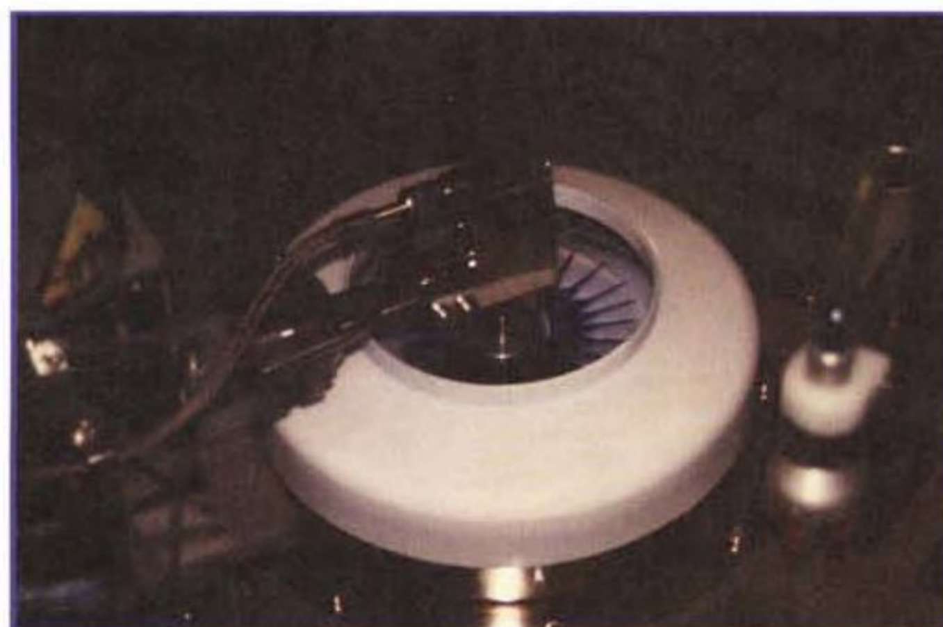
Ecco il momento della stesura del dye sul substrato. Il disco viene posto in rotazione e il dye si spande su di esso. Controllando la velocità di rotazione e la quantità di dye è possibile avere uno strato perfettamente uniforme.
