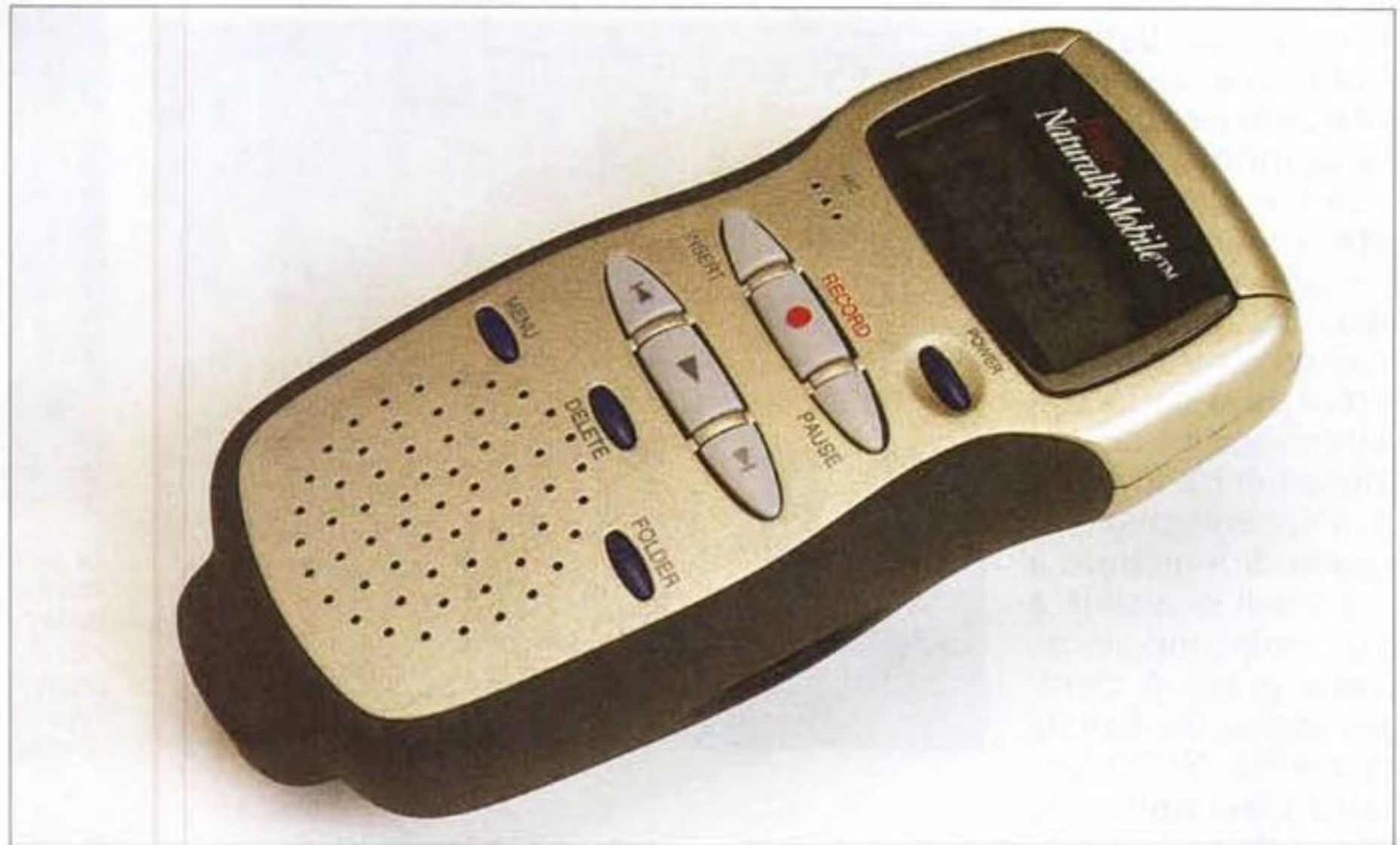
Il piccolo registratore, dal design elegante e funzionale, pesa circa 100 grammi, dispone di un'uscita USB per il collegamento al PC e di 4 Mbyte di memoria non volatile.
