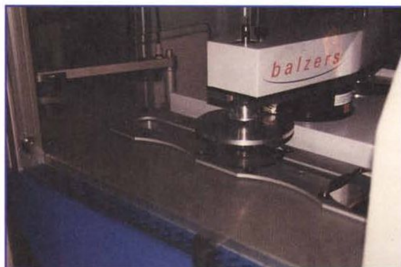
Il disco viene ora metallizzato: tramite una sofisticata apparecchiatura viene posto sul lato superiore del disco uno strato di argento di pochi micron di spessore, che realizzerà lo strato riflettente per il raggio laser.
