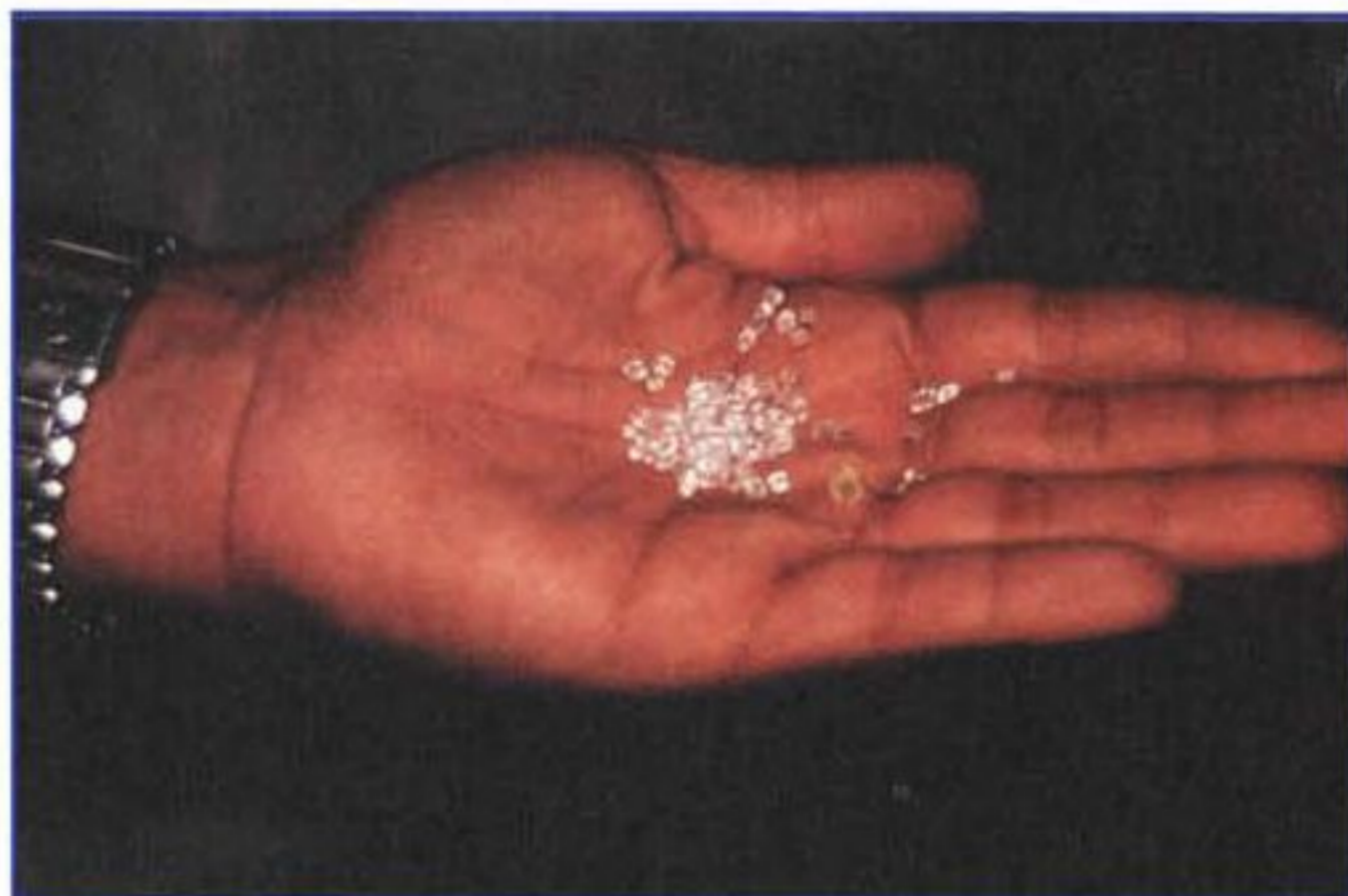
Partiamo dall'inizio del ciclo produttivo: questi sono granellini di policarbonato purissimo così come arrivano alla fabbrica (in sacchi dal peso di diversi chilogrammi). I granelli di policarbonato vengono inseriti in una macchina che li aspira e li trasporta nella pressa che serve a costruire il substrato.
