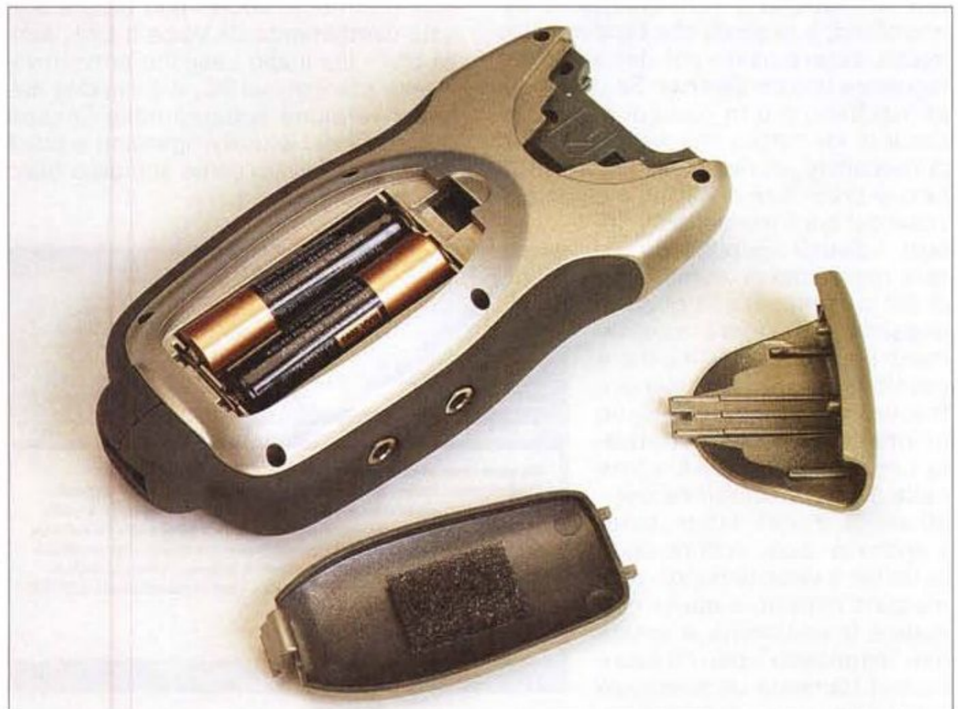
L'alimentazione del Naturally Mobile è assicurata da due comuni batterie mini stilo, mentre uno sportellino cela lo slot per schede di espansione di tipo SmartMedia.
