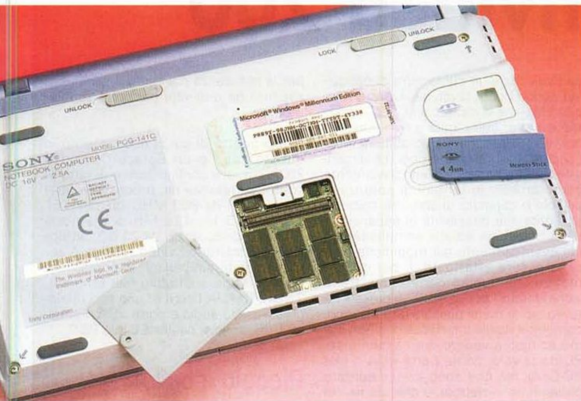
Sul fondo è presente il vano della memoria, espandibile fino a 192 MB, e una finestrella permette di verificare la presenza di una Memory Stick
