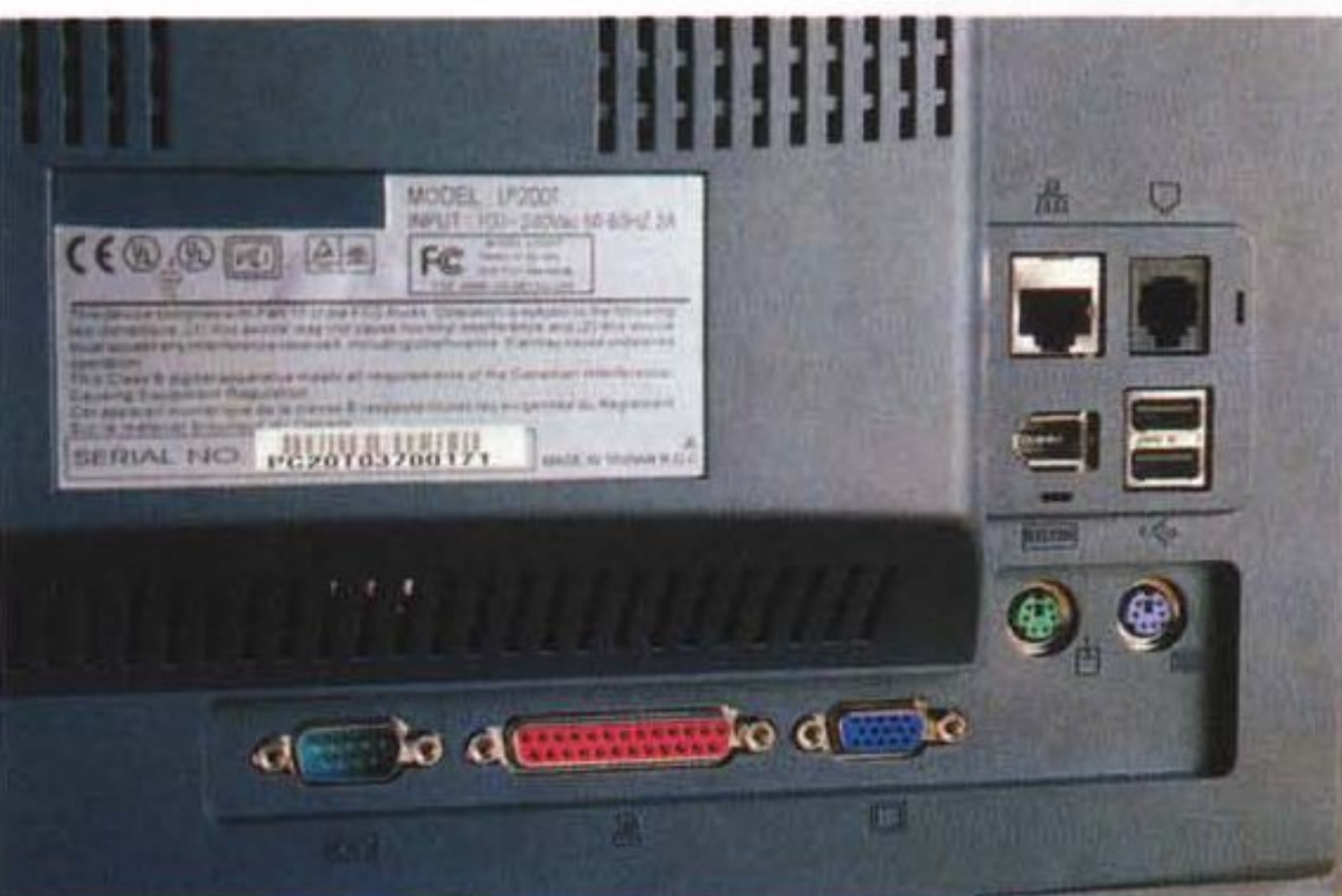
Tutte le porte dell'Envidea 200, ad eccezione degli I/O audio, sono posizionate sul lato posteriore. Abbiamo quindi, dall'alto verso il basso, i plug RJ45 e RJ11 dell'adattatore Fast Ethernet e del modem V90, interfaccia Firewire e USB, porte PS/2 per mouse e tastiera, seriale, parallela e connettore SVGA a 15 pin per il collegamento di un monitor esterno con supporto Dual View.
