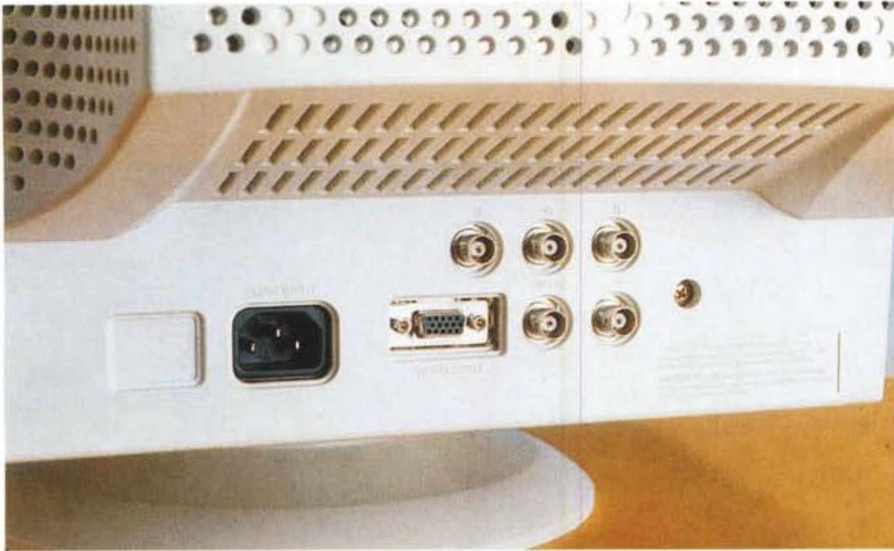
Due sono le possibilità di connessione: o usiamo il D-sub a corredo oppure ci procuriamo un cavo BCN e lo schermo è collegato!
