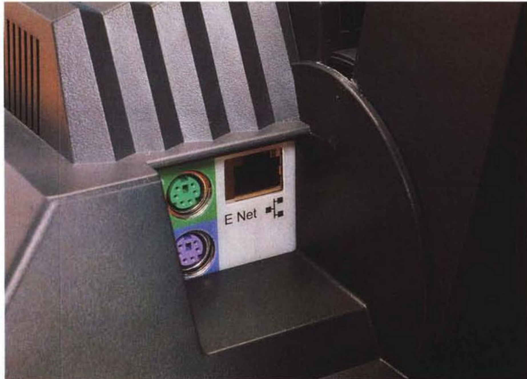
Le connessioni sono nascoste un po' ovunque. Manca l'uscita per un monitor esterno.
