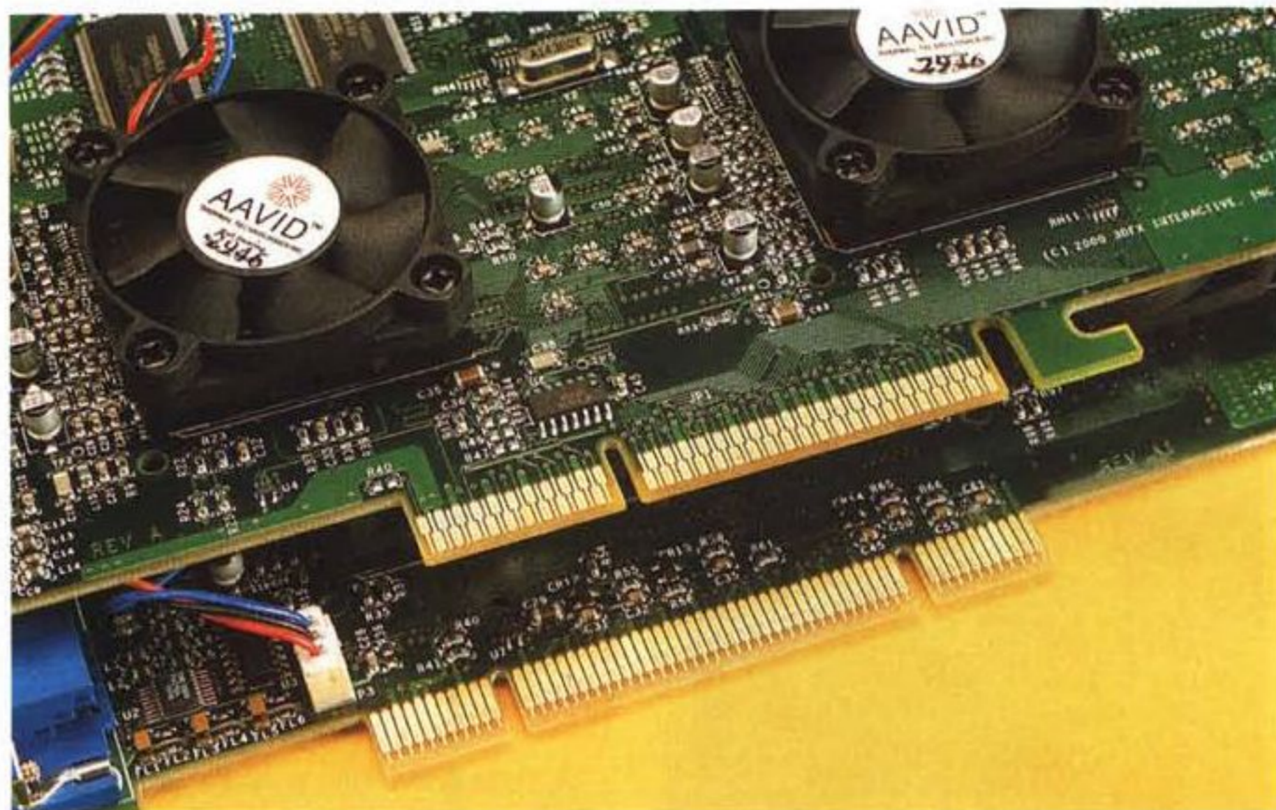
Il connettore PCI della versione Mac e quello AGP della versione PC. Oltre all'uscita supplementare digitale (presente solo sulla prima), è l'unica altra differenza sostanziale tra le due schede.
