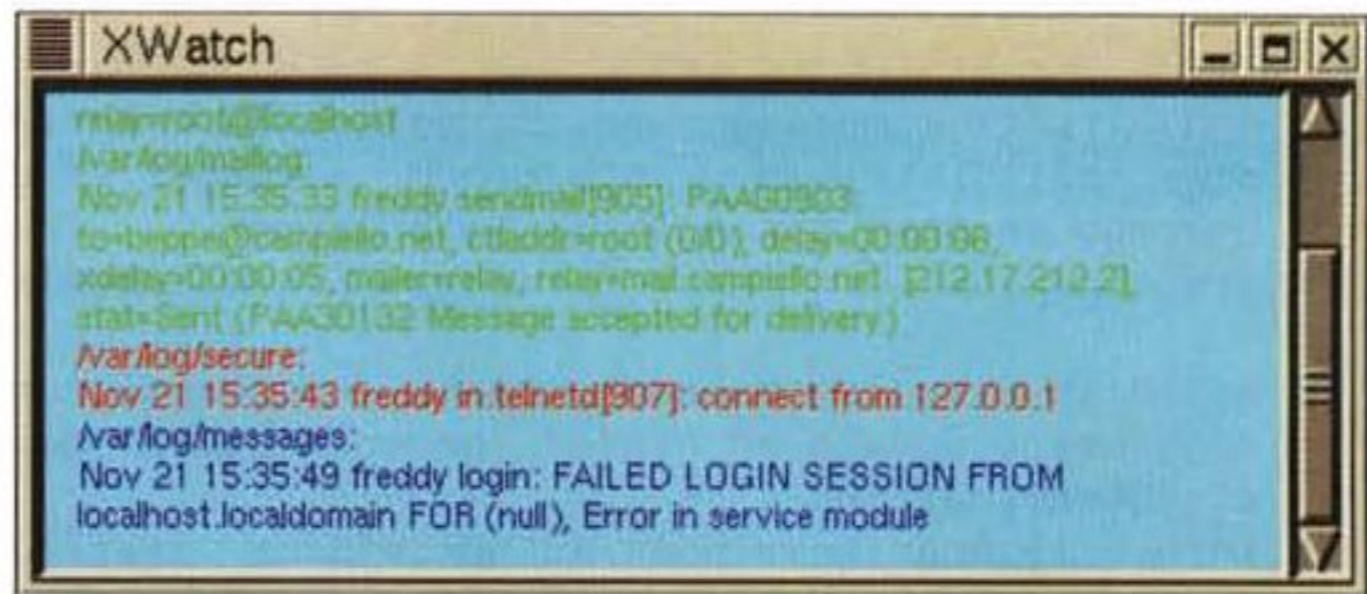
Xwatch permette di tenere sotto controllo contemporaneamente più file di log nella stessa finestra evidenziando ognuno mediante diversi colori.
