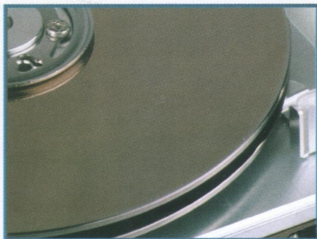
vi. In passato i dischi fissi utilizzavano motori "cadenzati" per spostare le testine di lettura, ma questi soffrivano di una mancanza di precisione che ne pregiudicava il funzionamento.
