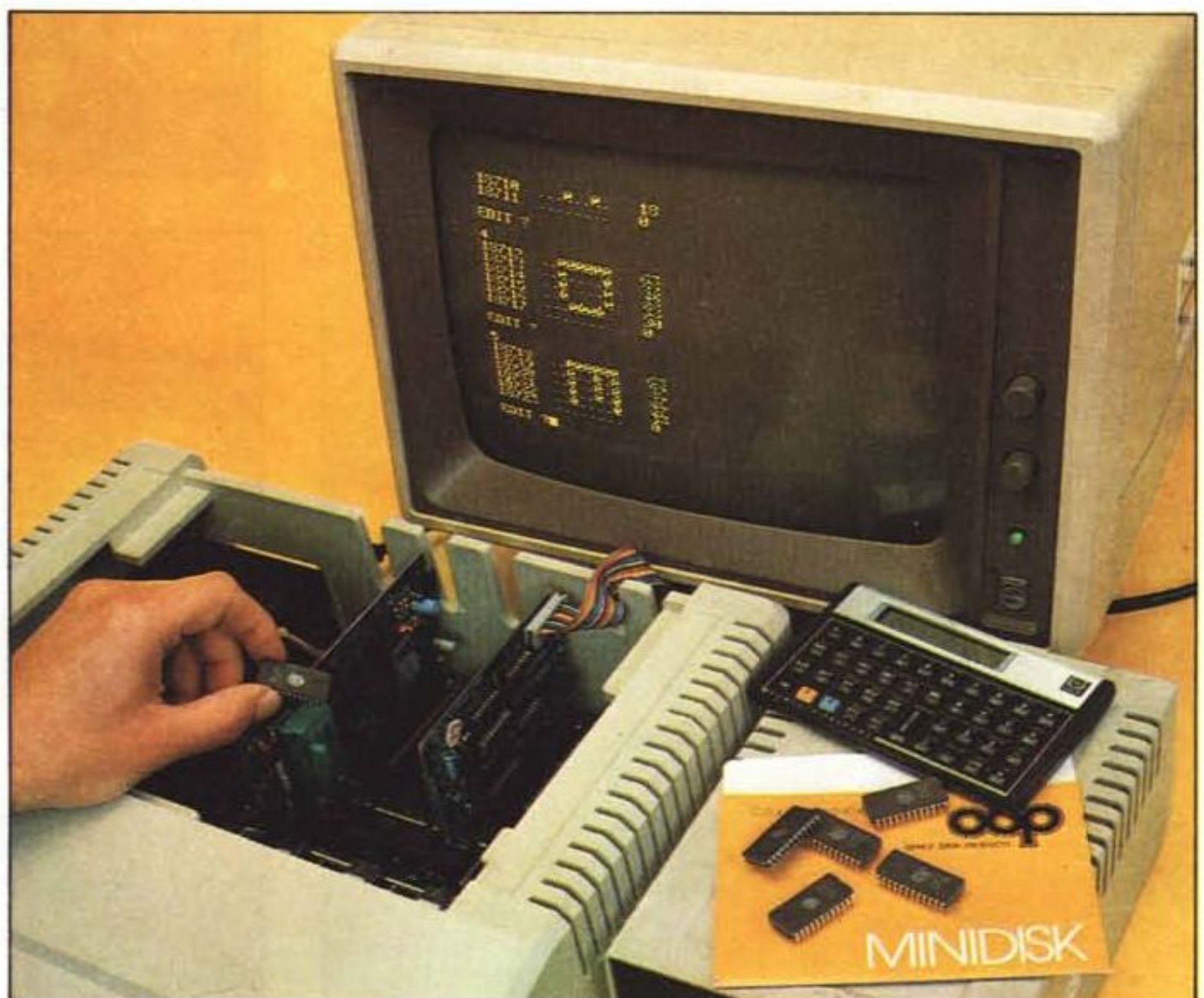
L'Apple-compatibile utilizzato per la lettura e la programmazione delle EPROM. Sul monitor la visualizzazione dei caratteri in memoria; nella macchina è installata la scheda di programmazione; sul drive la HP16C utilizzata per le conversioni bin-dec.
