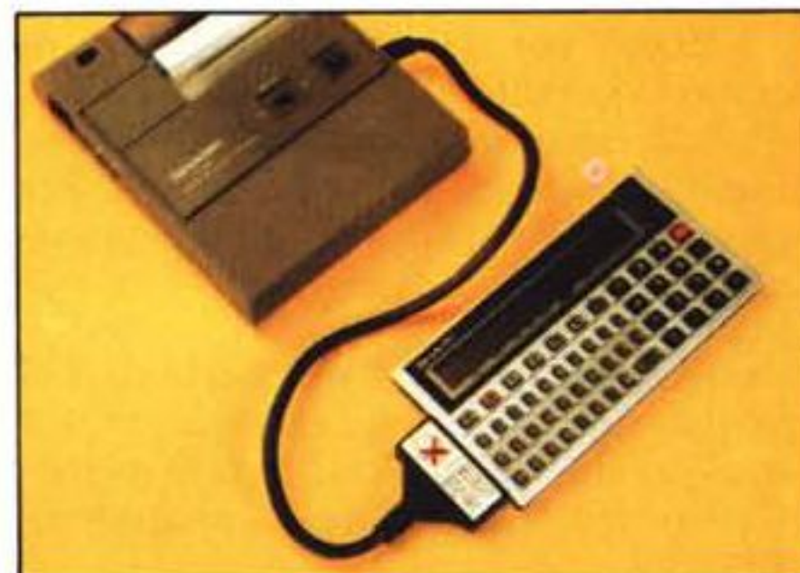
La stampante-interfaccia registratore CE 126P si collega ai pocket tramite cavo, e non rigidamente come la CE 125.
