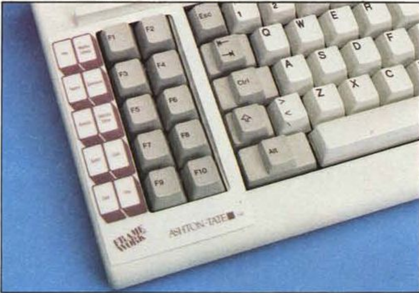
Le due mascherine autoadesive, dello stesso colore della tastiera, si applicano rispettivamente sui tasti funzione e sopra il tastierino numerico. I tasti più e meno del tastierino cambiano significato, per indicare somme e sottrazioni si devono necessariamente usare quelli della sezione alfabetica.
