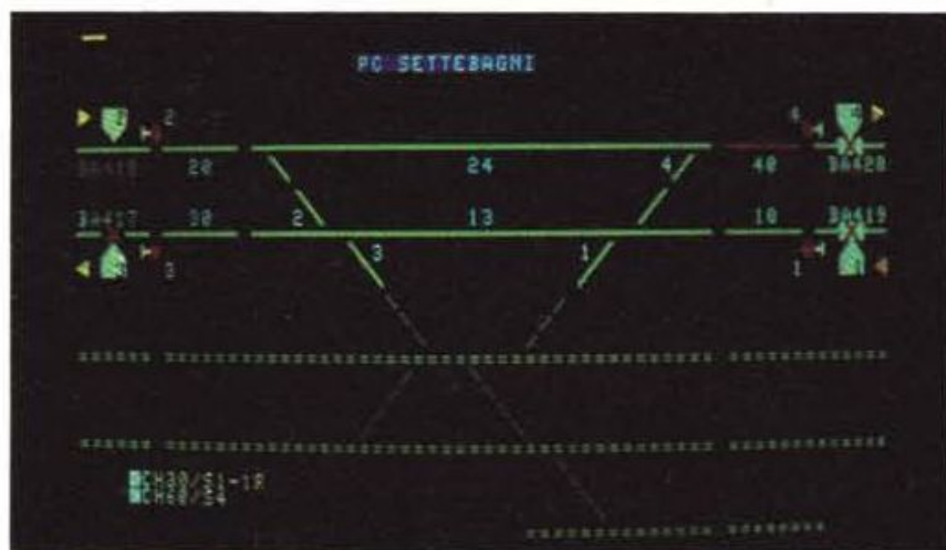
Quattro immagini dei monitor. In alto si vedono due tratti della linea, nella zona di Roma Settebagni e in quella di Orvieto. Le X rosse indicano dei fuori servizio, nel giorno in cui sono state fatte le foto, in quei tratti di linea. In quei punti, il traffico viene deviato sulla "linea lenta", ossia quella preesistente alla direttissima, schematizzata nella parte bassa dello schermo, tratteggiata quando non controllata tramite CTC; notare gli incroci a Settebagni, Baschi e Allerona. Le altre due schermate mostrano due "zoomate" sulle stazioni di Settebagni e Capena; a Settebagni si vede l'incrocio con la linea lenta e a Capena il binario di manovra (per il cambio di binario o lo spostamento di carrelli). Da notare, infine, lo stato dei segnali (il verde è segnalato bianco) e i numeri dei treni in transito (200 a Roma, 703 a Orvieto) con il ritardo (4 minuti il 200).
