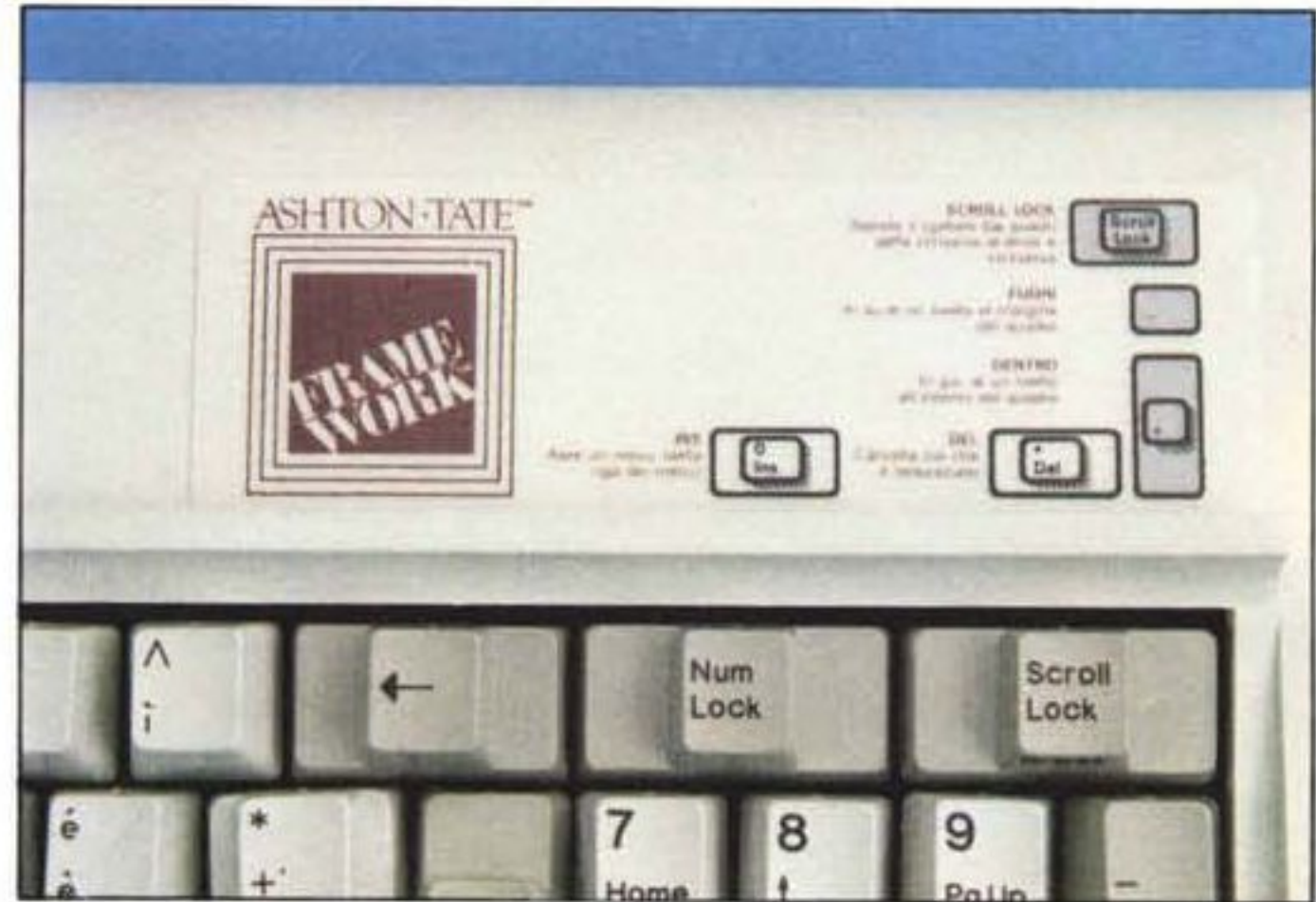
Le due mascherine autoadesive, dello stesso colore della tastiera, si applicano rispettivamente sui tasti funzione e sopra il tastierino numerico. I tasti più e meno del tastierino cambiano significato, per indicare somme e sottrazioni si devono necessariamente usare quelli della sezione alfabetica.
