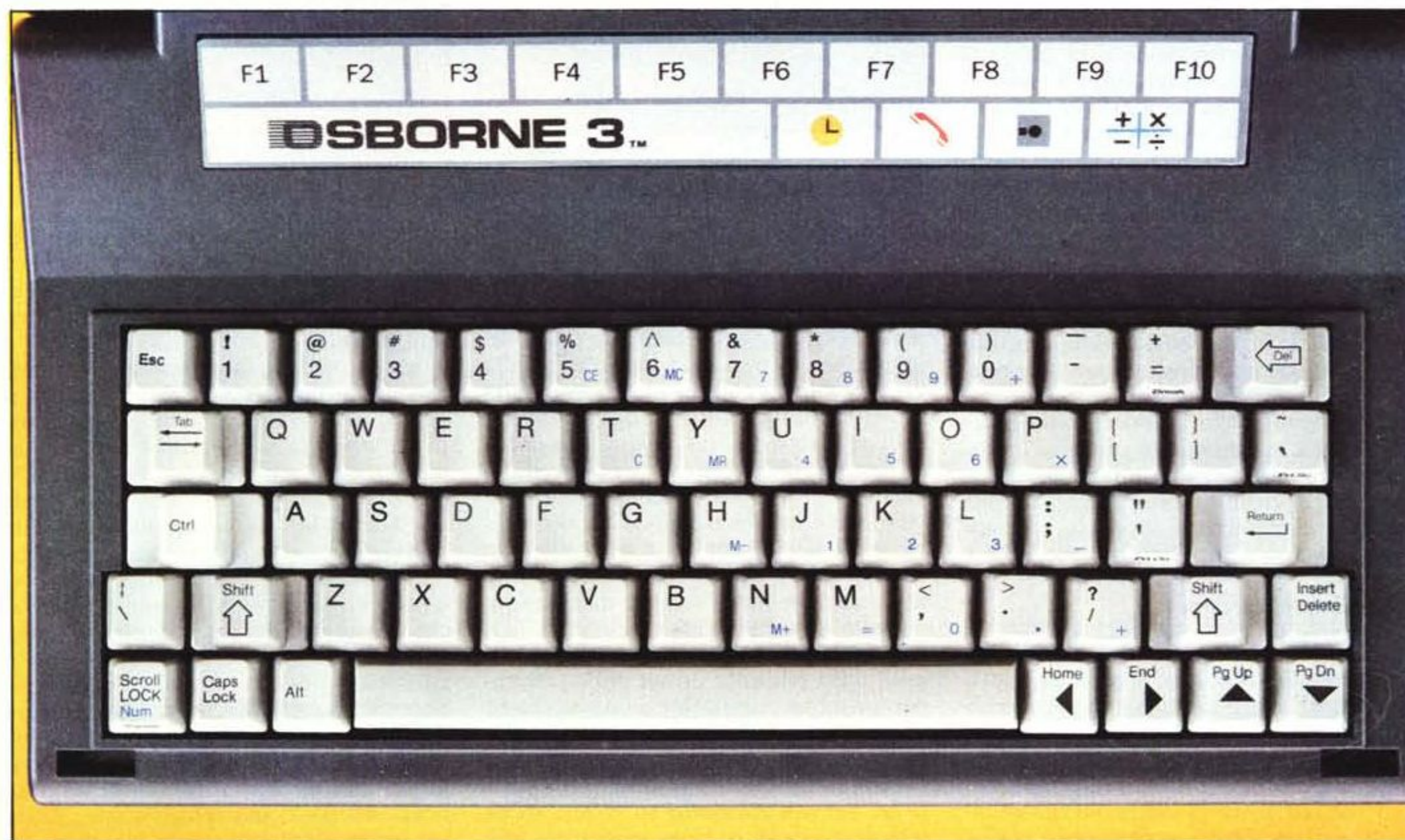
La tastiera dell'Osborne 3 è divisa in due sezioni. Quella in alto attiva anche i programmi su firmware. Notare il tastierino per la calcolatrice nascosto fra i tasti alfabetici.
