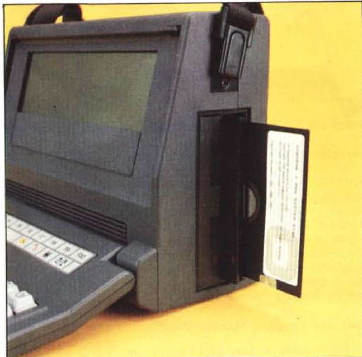
Sopra, una vista dell'Encore lato controlli. A tastiera chiusa l'area di base è veramente ridotta. A destra il lato opposto, con i due drive ultrasottili. Gli sportelli si aprono applicandovi una pressione, ed il dischetto viene espulso fuori.
