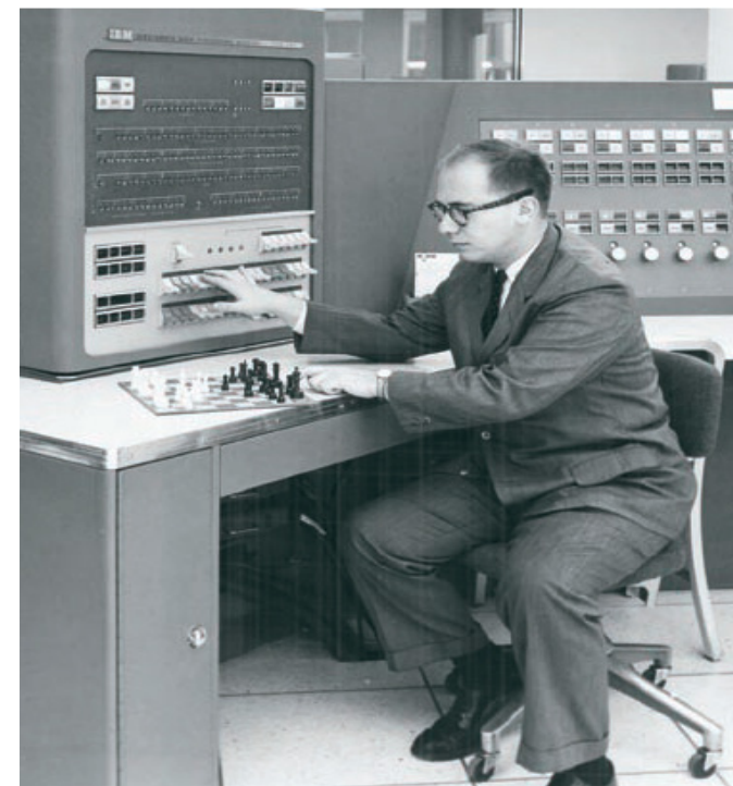
Fig. 6 - Il programmatore Alex Bernstein della IBM scrisse un programma per il mainframe 704 nel 1958. In questa foto sta comunicando la sua mossa agendo sugli switch del pannello di controllo.
