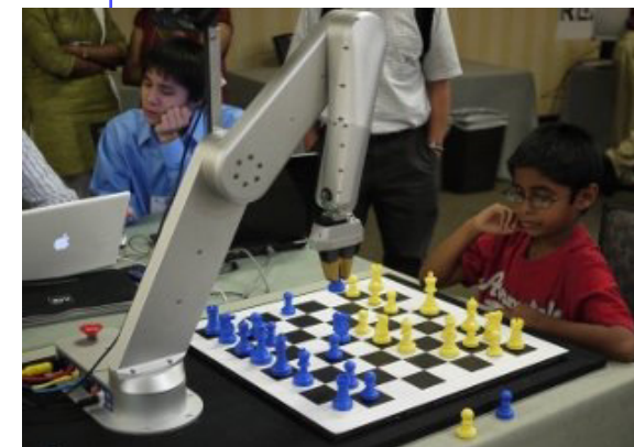
Fig. 1 e 2 - In apertura il set della Digital Game Technology (DGT) project group, un gruppo di ricerca attivo all'Università della Malaysia; offre a basso costo una soluzione per interfacciare una tastiera con il PC attraverso un controller che usa un PIC18F452, della Microchip Technology Corporation - Qui sopra Gambit, un robot con braccio meccanico che "vede" i pezzi, anche se sono disposti male o la tastiera non è perfettamente posizionata.
