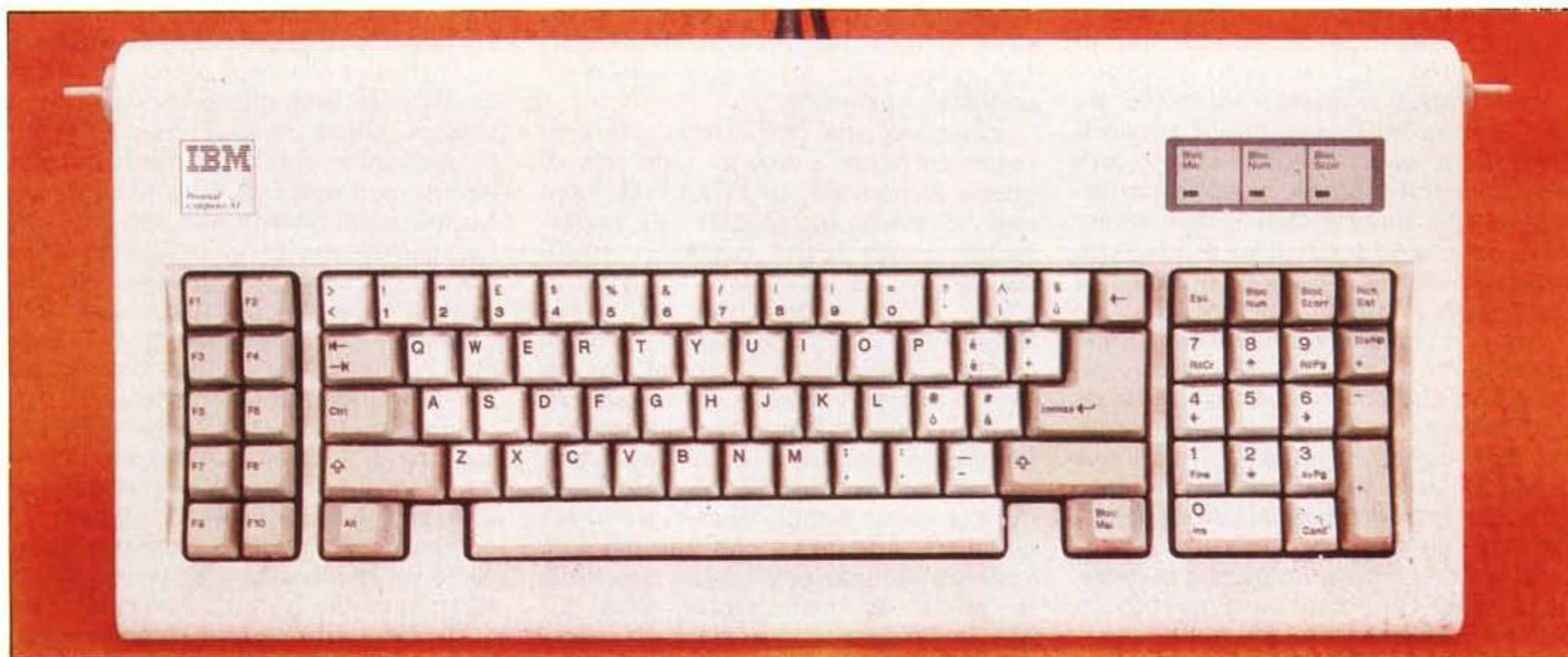
La tastiera dell'AT è di altissima qualità. Si differenzia da quella del PC per il layout dei tasti, ora con scritte in italiano, e per la presenza delle spie di Lock.
