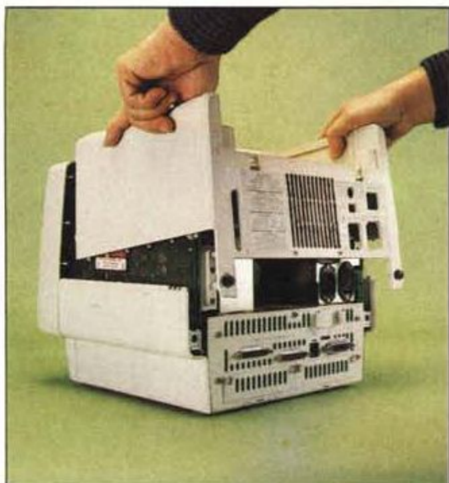
Allentate le due viti brunite, tirare leggermente a sé e sollevare la parte superiore del mobile.
