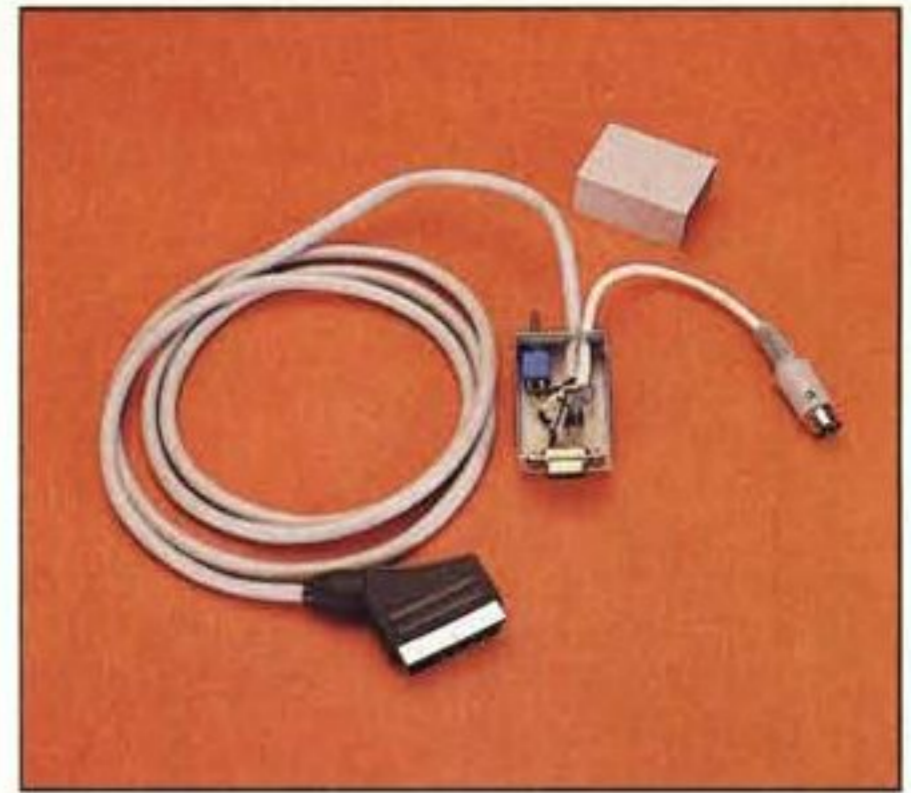
In queste tre foto si possono vedere i prototipi realizzati per i collegamenti video. A sinistra, i cavi per la connessione di un display monocromatico che permette di visualizzare 80 colonne (cavo di sinistra) oppure 40 colonne (cavo di destra). Al centro si può invece osservare il cavo con lo switch di selezione per commutare sullo stesso monitor 40 oppure 80 colonne. Infine, nella foto di destra è visibile il cavo per la visualizzazione di 40 oppure 80 colonne a colori rispettivamente in composito ed in RGB su monitor con presa SCART.
