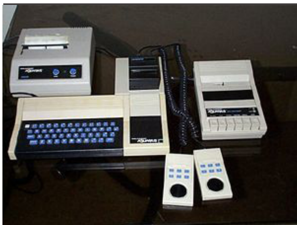
Una postazione di lavoro completa con registratore a cassette e stampante termica a 40 colonne.
