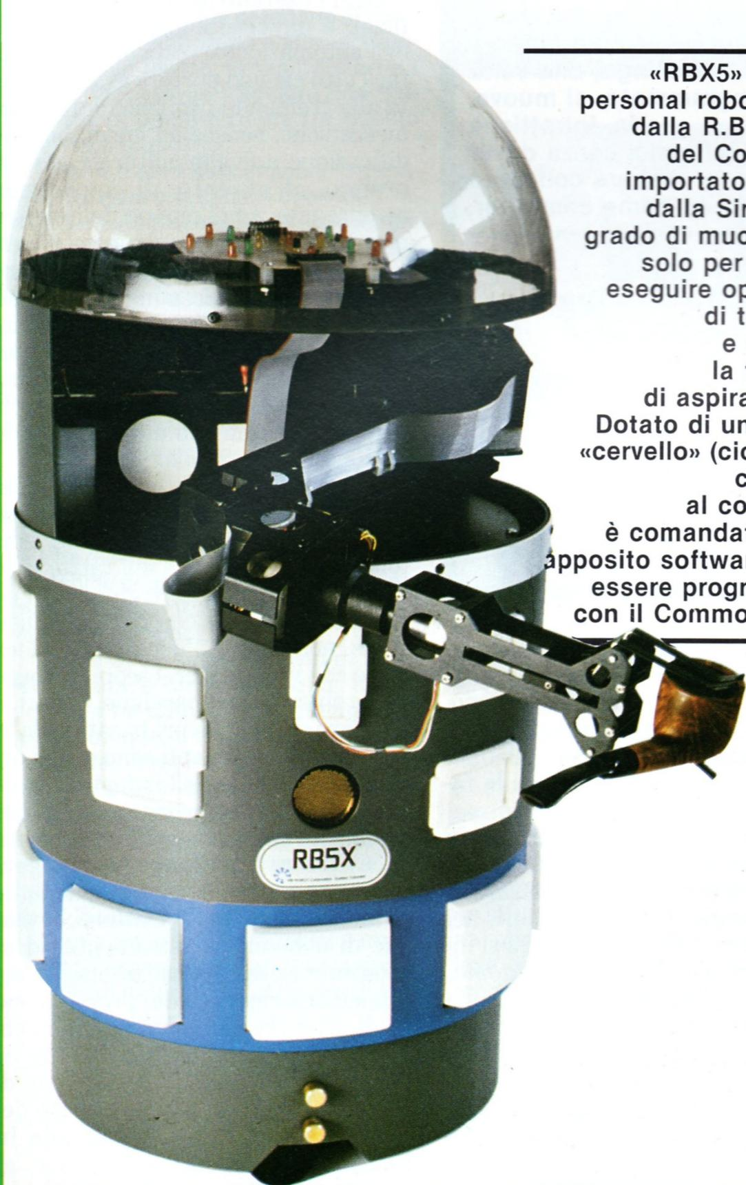
«RBX5» il nuovo personal robot creato dalla R.B. Robots del Colorado e importato in Italia dalla Sirius, è in grado di muoversi da solo per la casa, eseguire operazioni di trasporto e svolgere la funzione di aspirapolvere. Dotato di un proprio «cervello» (cioè non è collegato al computer), è comandato da un apposito software o può essere programmato con il Commodore 64.
