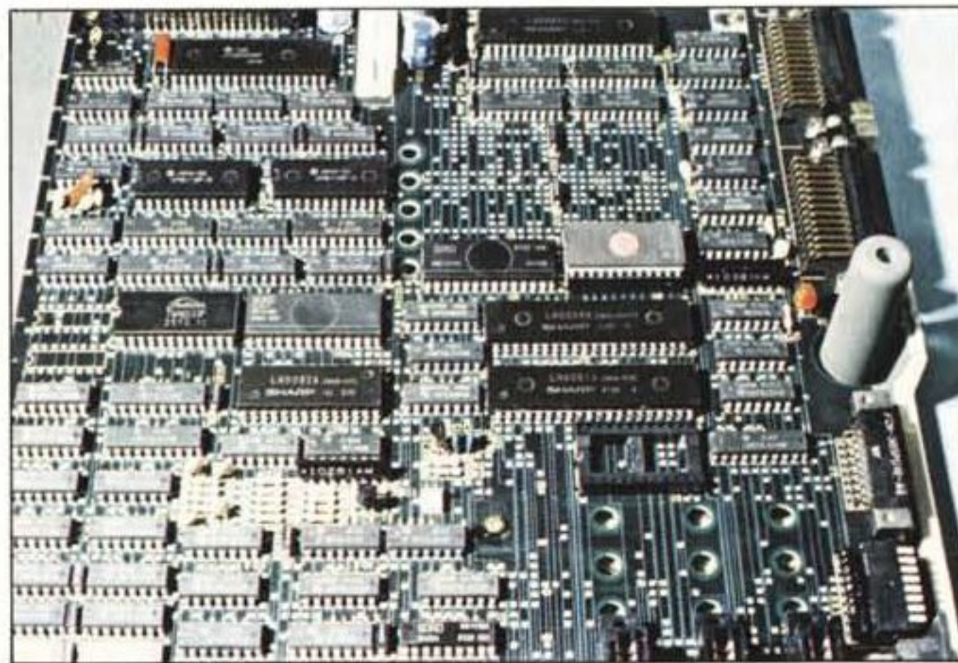
Con il procedere della miniaturizzazione le dimensioni della sezione elettronica dei computer si riducono sempre più: processore, 128 kbyte RAM, porte di I/O slot trovano posto in un'unica piastra stampata non più grande di 30 \times 40 cm.
