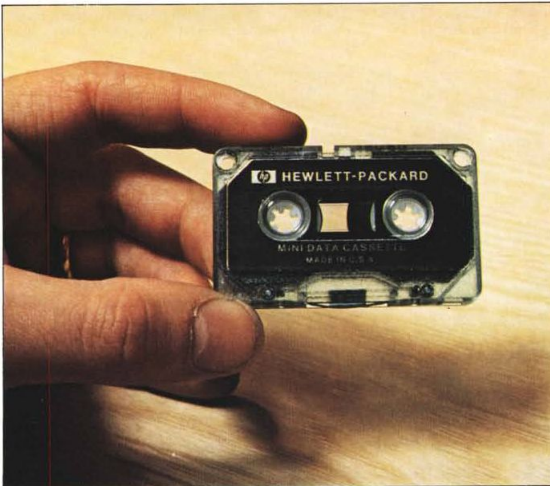
L'82161A utilizza una minicassetta simile a quella impiegata nei microregistratori audio per appunti e interviste.
