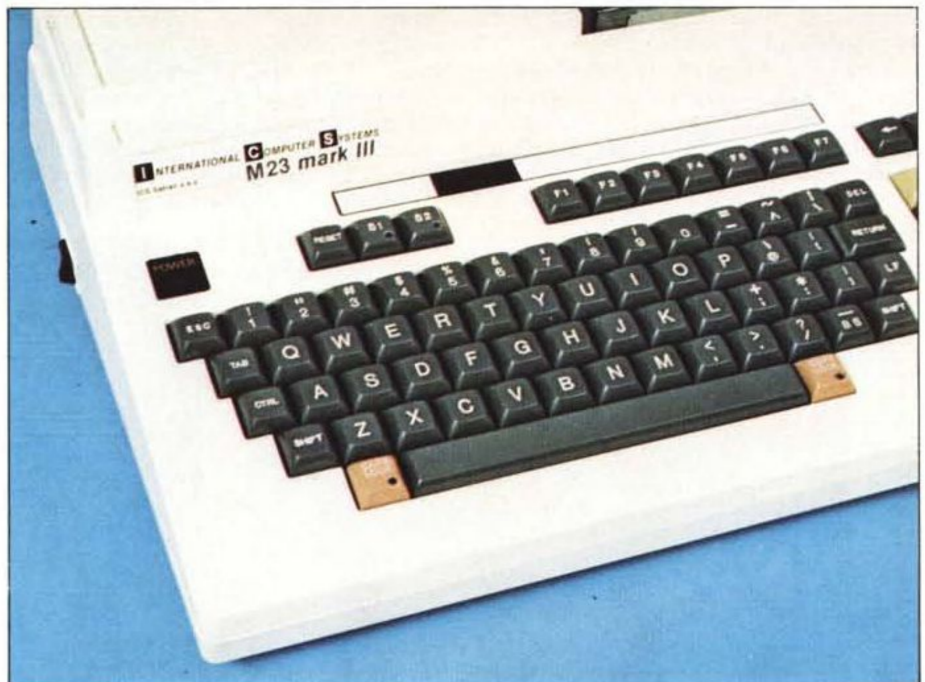
Una vista della tastiera. Notare i tasti di "sense" S1 e S2, i tasti definibili da F1 a F7 e i due CAPS LOCK ai lati della barra spaziatrice.
