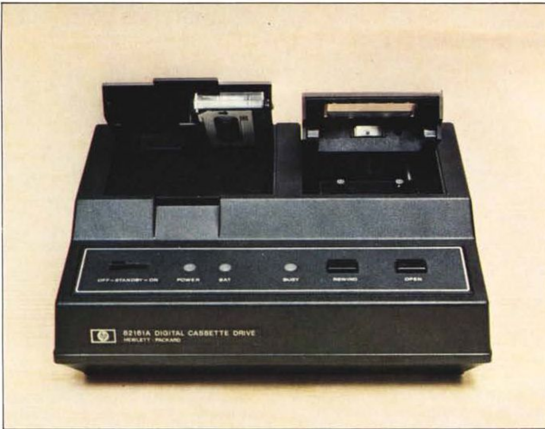
Il registratore 82161 A: si nota, a destra, la testina magnetica.
