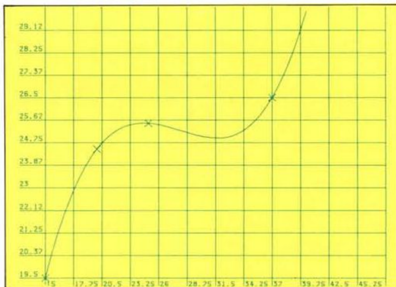
Figura 9 — Output su plotter del Programma di Regressione Polinomiale. Il programma mostra sia i punti corrispondenti ai valori empirici, sia la curva di regressione. Se l'ordine del polinomio è pari al numero dei punti immessi meno uno, la curva passa per tutti i punti.
