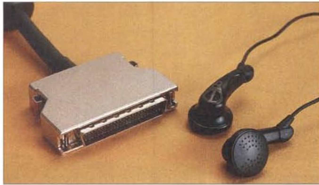
Particolare del connettore SCSI-II e degli ottimi auricolari in dotazione: malgrado l'aspetto economico, questi oggettini "suonano" in modo egregio, secondo noi meglio di quanto non riproduca il masterizzatore...
