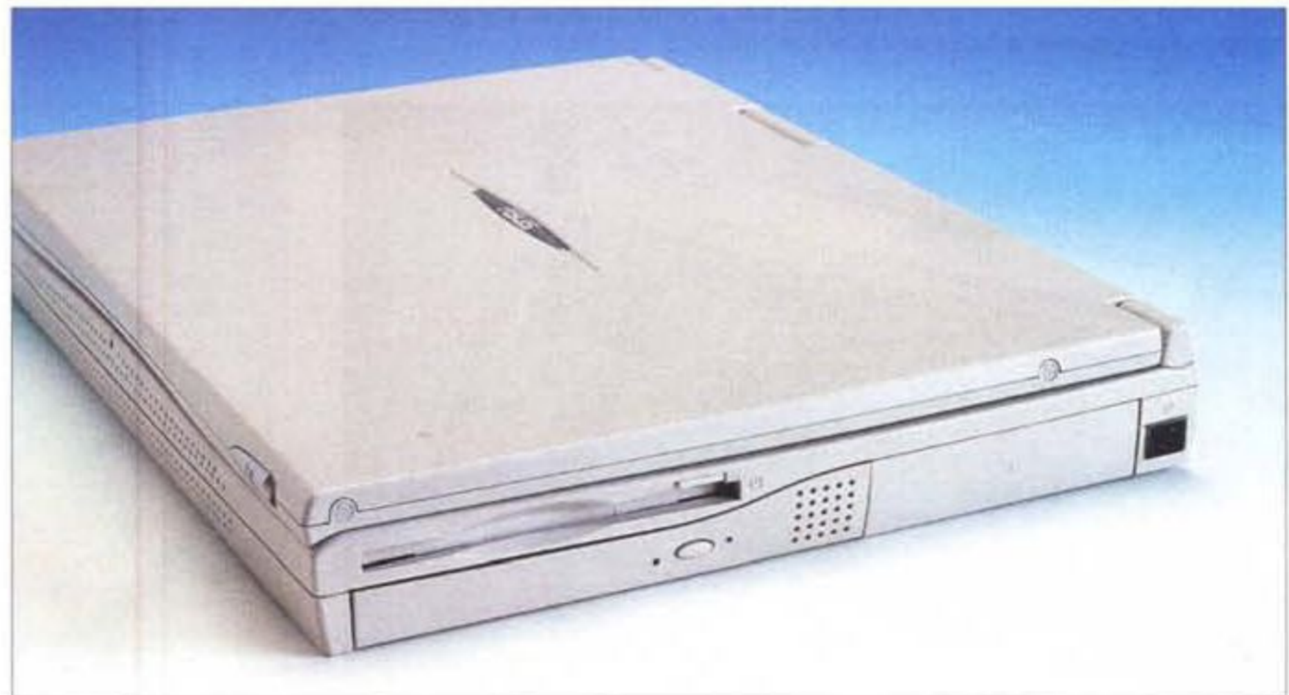
Sul lato destro sono presenti il lettore di floppy disk, e il lettore DVD-ROM. Più a destra, dopo l'alloggiamento dell'hard disk troviamo una porta di comunicazione seriale a raggi infrarossi.
