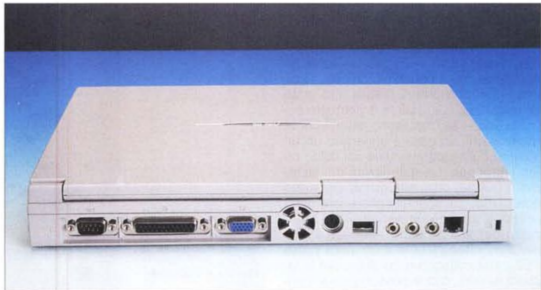
Sul pannello posteriore, oltre alla ormai consueta porta USB, sono presenti anche una seriale RS-232, la porta per la stampante, l'uscita SVGA per il monitor esterno e un'unica presa PS2 per il collegamento di mouse e tastiera esterni, che si possono avere insieme mediante un adattatore ad Y. Sempre sul lato posteriore sono situate le prese audio e una presa per il modem interno, che nella macchina in prova non è installato.
