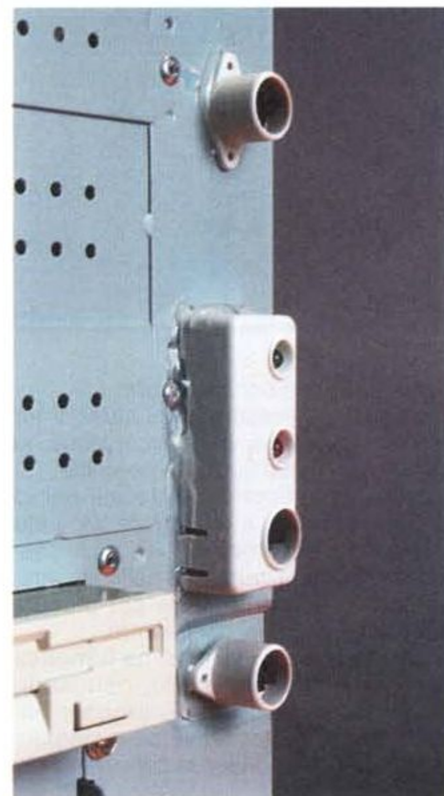
Gli incastri tra la struttura metallica del cabinet e gli accessori in plastica: l'assemblatore ha curato anche questo dettaglio, utilizzando della colla termofusibile per evitare spostamenti.
