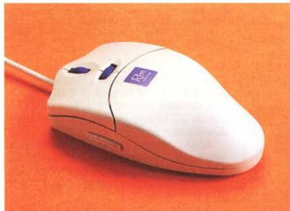
Il mouse è dotato di due rotelline e tre pulsanti: purtroppo, il terzo tasto è posizionato in corrispondenza della presa (dove poggia il pollice durante l'uso), ed è molto scomodo da usare.
