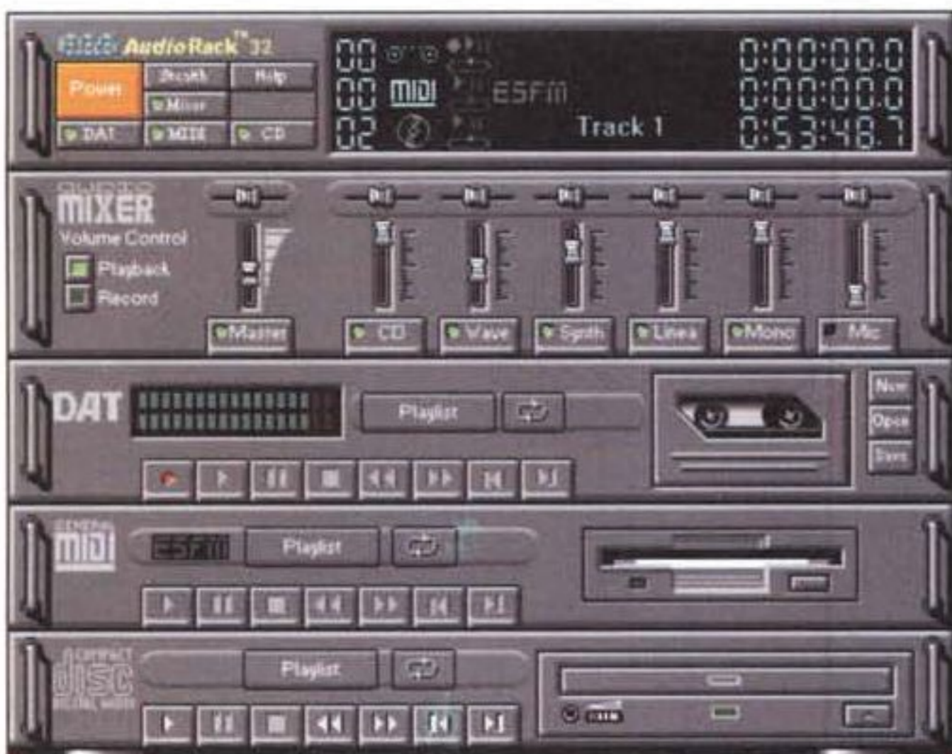
L'AudioRack come modulo di controllo di tutte le componenti (anche aggiuntive come la card radio-tuner) del sistema DMX.
