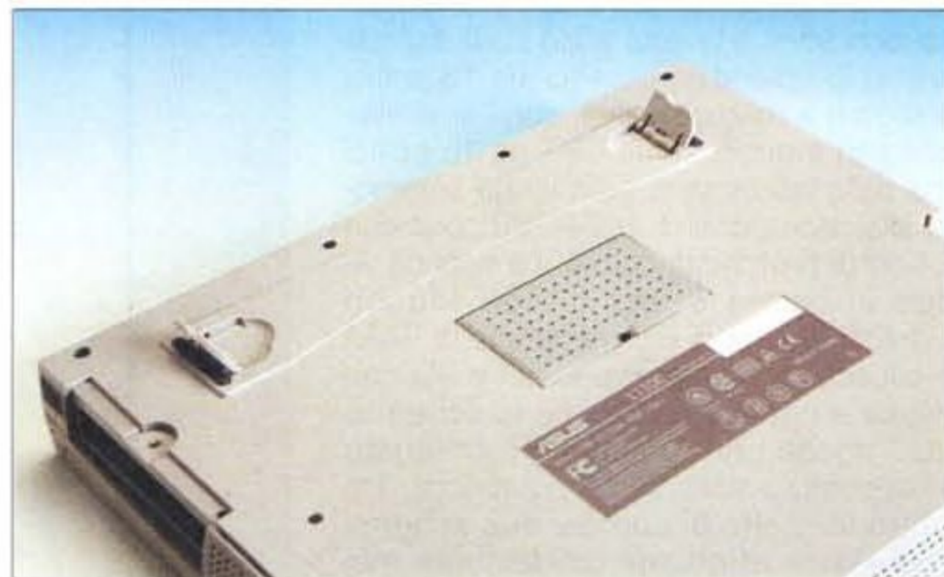
Nella parte inferiore del case sono presenti due piedini estraibili che permettono di inclinare il computer in avanti per rendere più comodo l'uso della tastiera.
