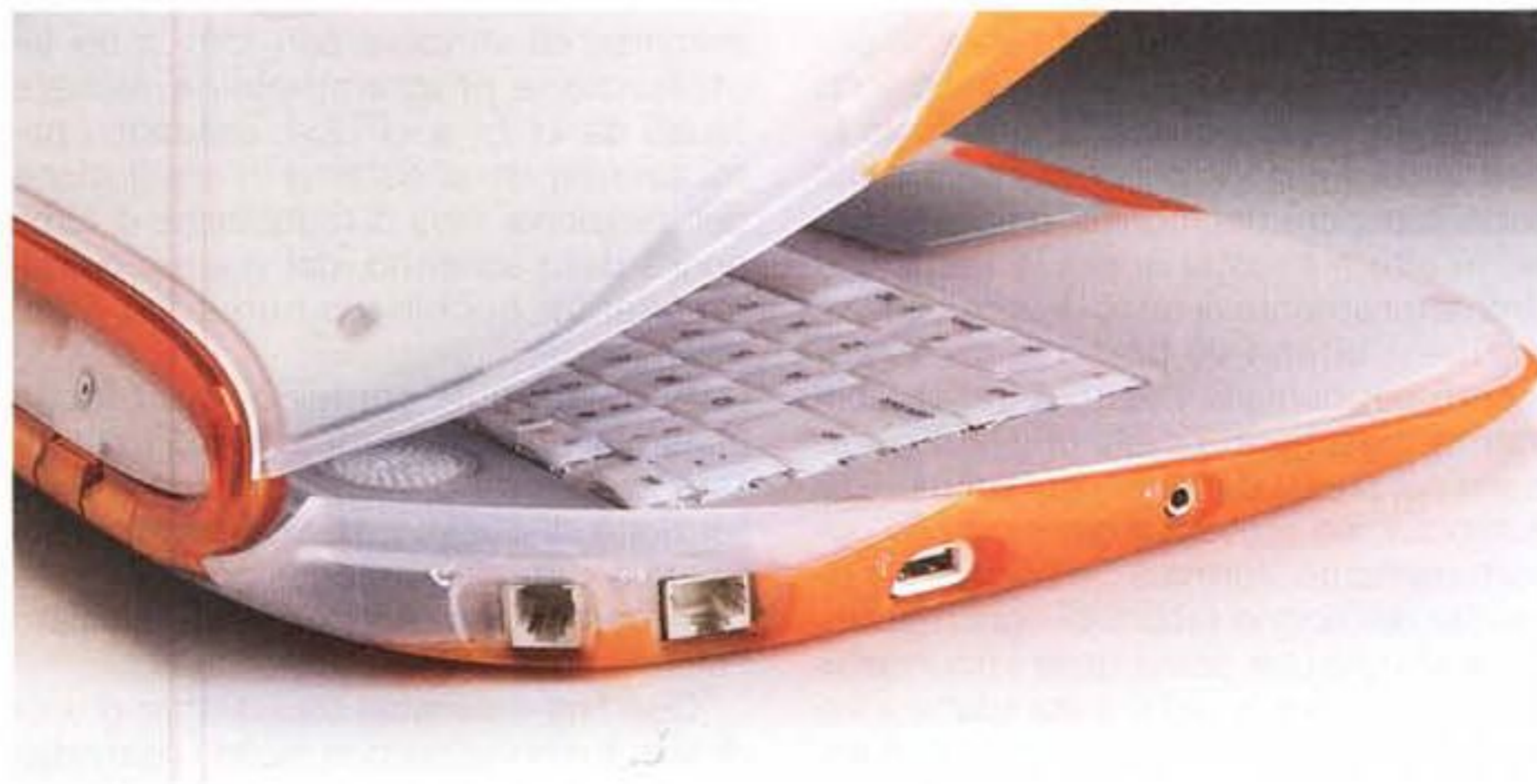
Sul lato sinistro trovano posto il terminale telefonico, quello di rete Ethernalk, il connettore USB e il jack stereo.
