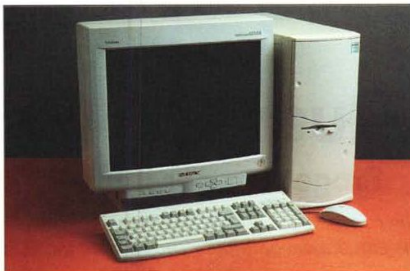
La macchina utilizzata per i test è stata fornita dalla Infoware S.p.A.. La configurazione, come descritto nell'articolo, utilizza un processore Intel Celeron 433 e la scheda madre Asus MEL-M basata sul nuovo socket 370. Infoware S.p.A. - Via Boldetti, 29 - 00162 Roma - Tel. 06/86321576
