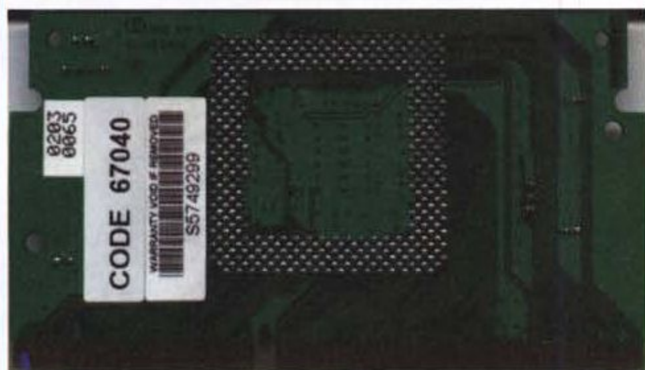
Figura 2 Per imporre la tensione di alimentazione del nucleo a 2.2 V occorre isolare i pin A119, A121 e B119. L'isolamento si può mettere in atto utilizzando nastro adesivo isolante, scotch oppure nastro da pacchi.
