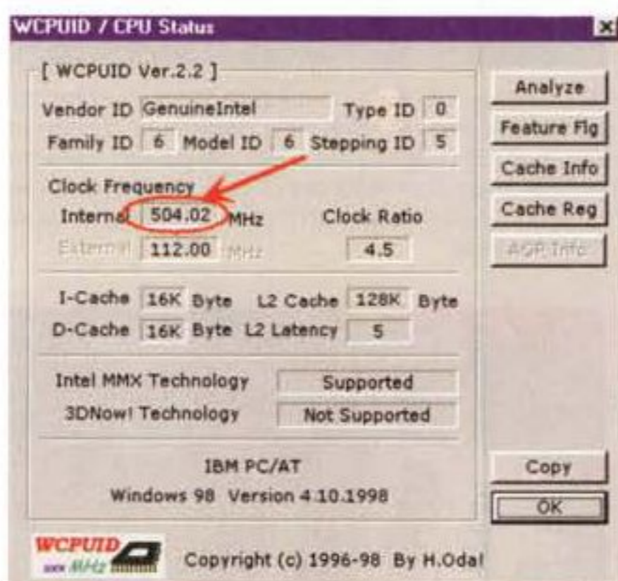
Figura 1 Celeron 300A portato a 504 MHz grazie all'aumento della tensione di alimentazione a 2.25 V ed una frequenza di clock della scheda madre di 112 MHz. Spesso per raggiungere questi risultati occorre aumentare la tensione di alimentazione fino a 2.4 V. E' una operazione le cui conseguenze sono a carico di chi le mette in opera!
