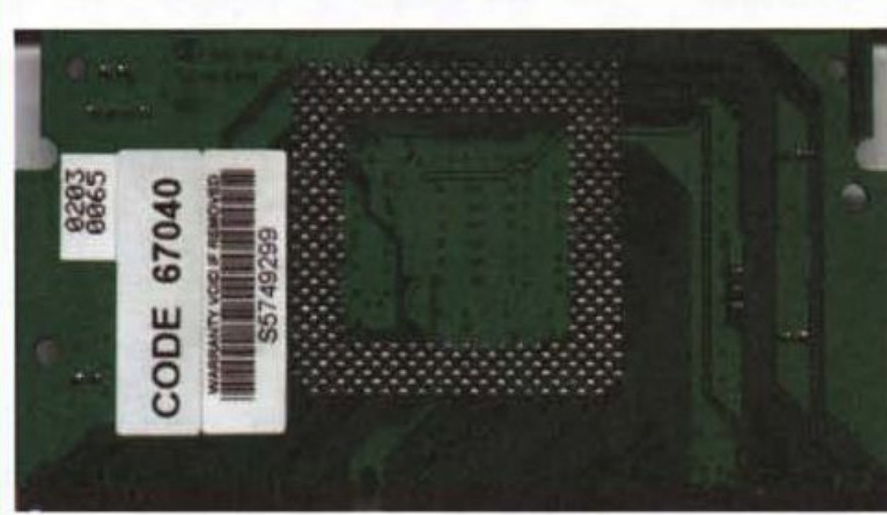
Figura 3 Per portare la Vcc a 2.4 volt occorre isolare i pin A120, A121 e B119. Ultima spiaggia dell'overclocker veramente intrepido.
