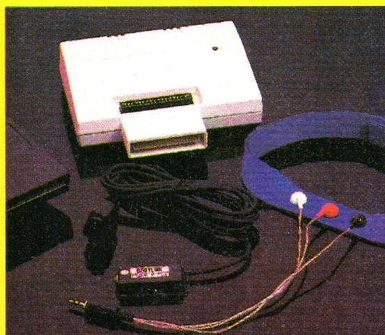
re coscienza dei suoi sintomi più eclatanti, come la tensione muscolare e la temperatura della pelle, eliminandoli poi con la tecnica del biofeedback. Il package comprende, oltre al Bodylink, un sensore elettromiografico completo di elettrodi, cuffia e cavetti, un sensore di temperatura e due cartucce di software.
