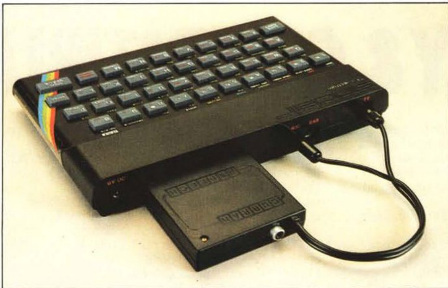
Nella foto si vedono i collegamenti necessari per l'installazione dell'interfaccia. Dal contenitore escono due cavi, il primo va alla presa MIC, il secondo all'uscita TV.
