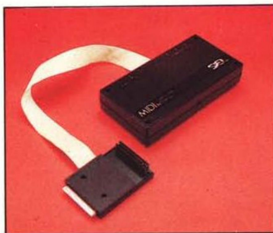
L'interfaccia MIDI, che permette di controllare un sintetizzatore con un computer.
