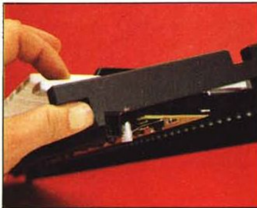
La meccanica della tastiera, che grazie al doppio contatto permette all'elettronica di "capire" la forza con cui viene premuto il tasto. A destra un'immagine del programma che simula i controlli della tastiera.
