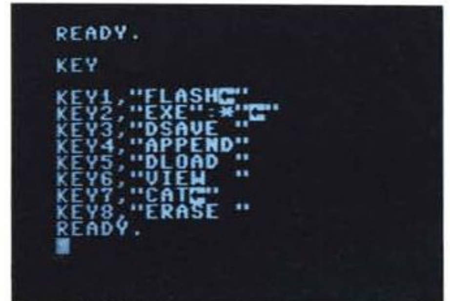
Il comando KEY attiva i tasti F1-F8 e mostra le definizioni correnti.
