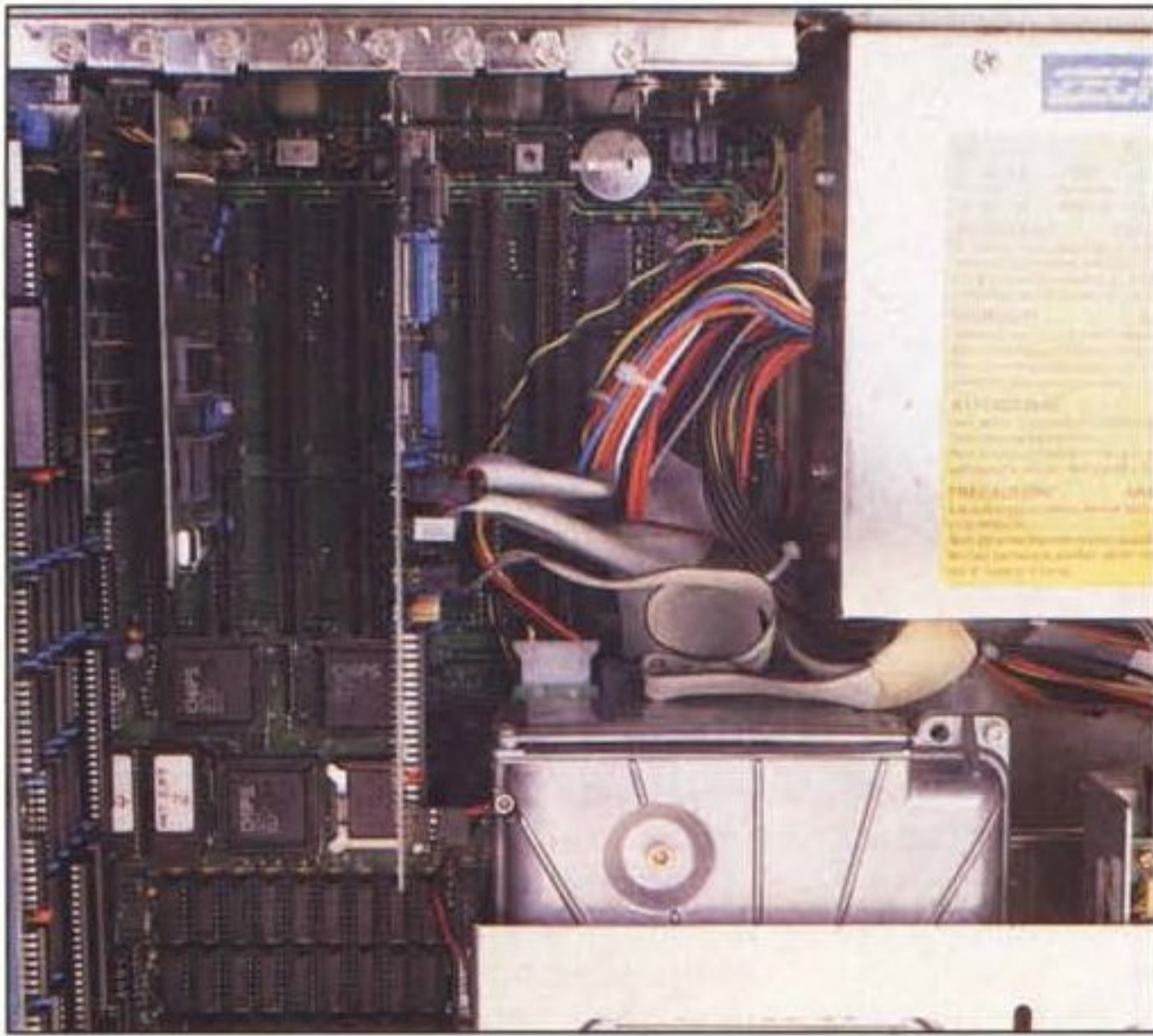
Sopra: la particolare posizione del winchester rende inutilizzabile uno dei due slot «corti». In alto a destra, lo spazio sotto ai drive. A fianco il controller dei dischi ed in basso la EGA.
