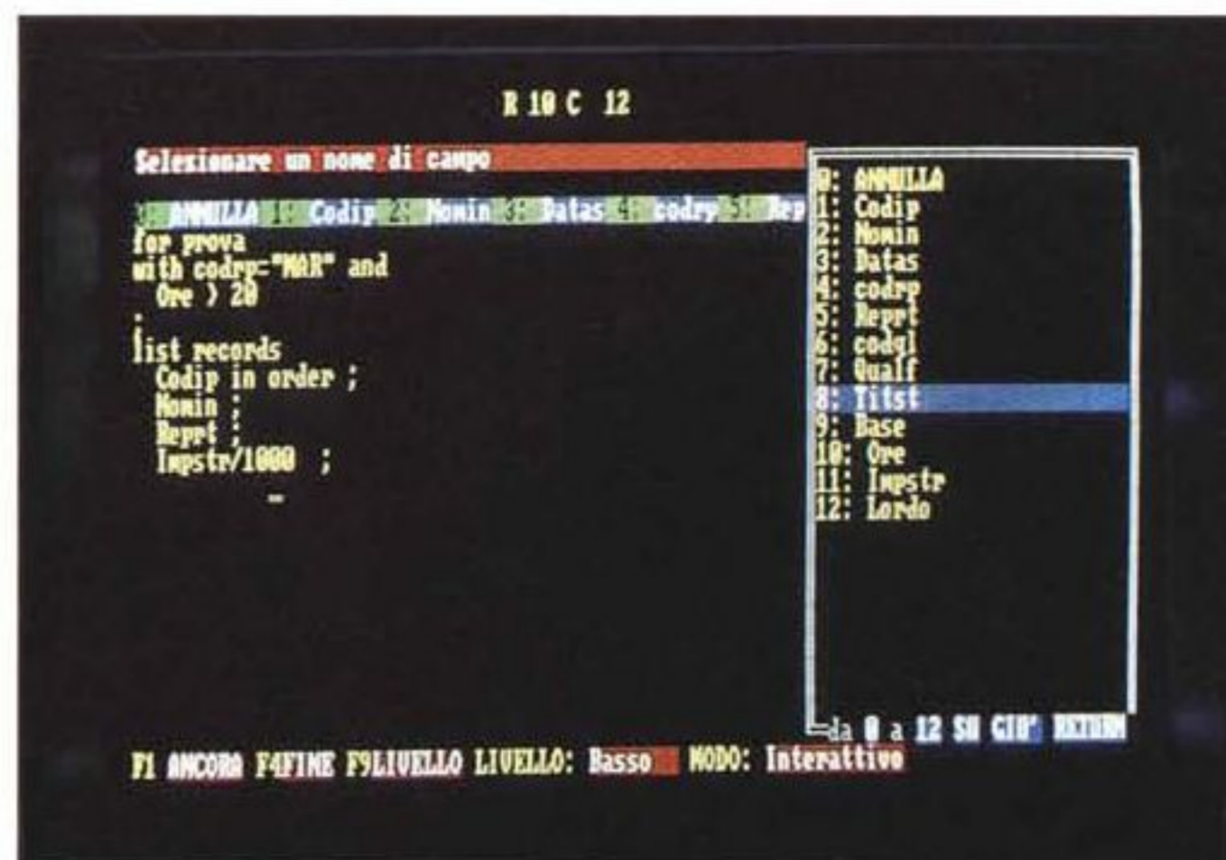
Figura 11 - Esempio di Programmazione in DataEase. Si possono costruire sia elaborazioni che producono un Report, sia elaboratori definiti Batch, che lavorano su tutto l'archivio, anche con operazioni di aggiornamento dei dati in esso contenuti.
