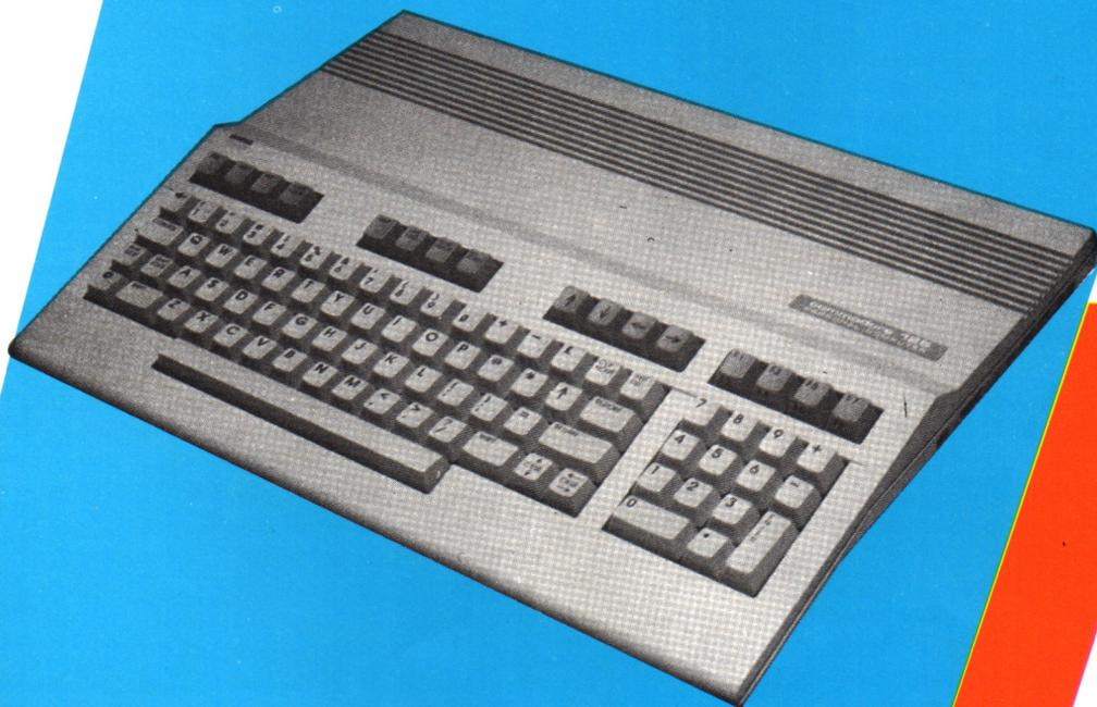
porta esattamente come un Commodore 64, appare il solito "38911 byte free", ed è disponibile solo uno schermo a 40 colonne. L'inizializzazione viene fatta dal Basic tramite il comando 'GO 64', oppure la macchina andrà automaticamente nel modo 64K all'accensione se verrà inserita nell'ingresso espansione giochi una cartuccia Commodore.
