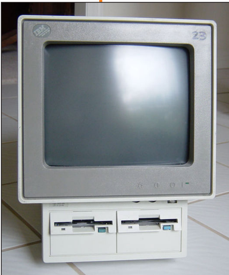
La macchina PS/2 mod. 25 di IBM. Un sistema che porta a bordo la tecnologia Micro-Channel.
