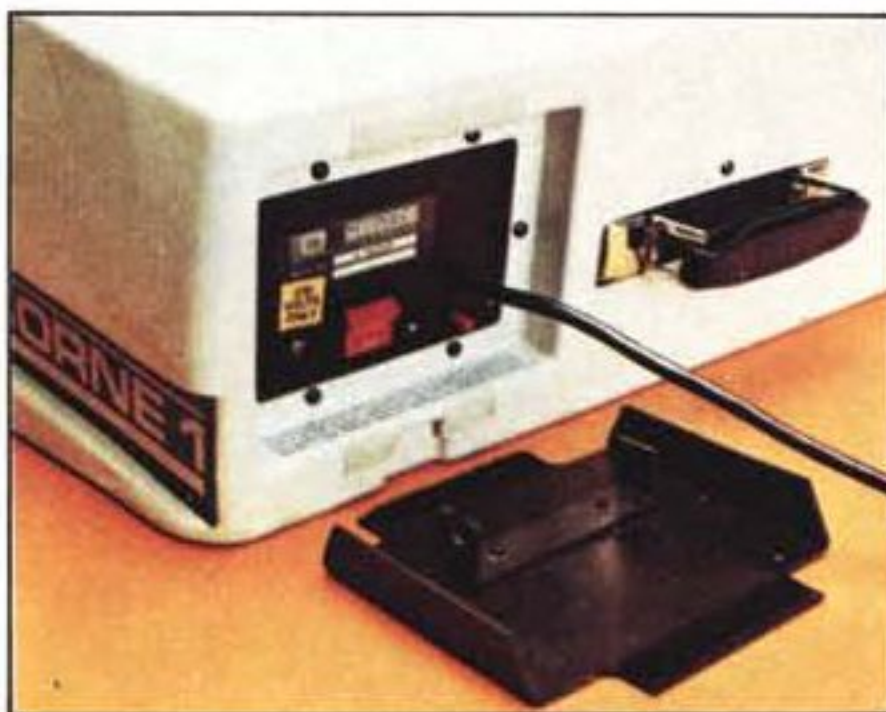
Nel piccolo vano sul retro trovano posto l'interruttore, il pulsante di ripristino dell'alimentazione e, durante il trasporto, il cordone arrotolato.
