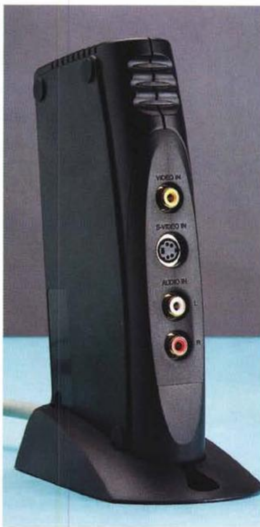
Le connessioni In/Out del Box esterno: a) vista frontale, con le connessioni audio/video d'ingresso al sistema; b) vista posteriore con le connessioni audio/video d'uscita verso periferiche analogiche (TV e VCR).
