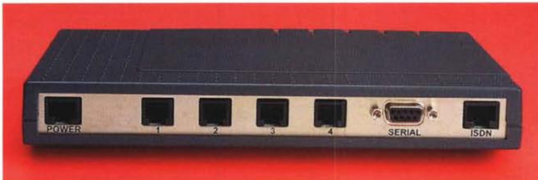
Sul retro trovano posto tutte le connessioni: la porta seriale per il collegamento al PC, il connettore della linea ISDN, quello per l'alimentatore (simile a quello telefonico ma con un incastro personalizzato) e i quattro plug per le periferiche analogiche (telefoni, fax, segreterie telefoniche, ecc.).
