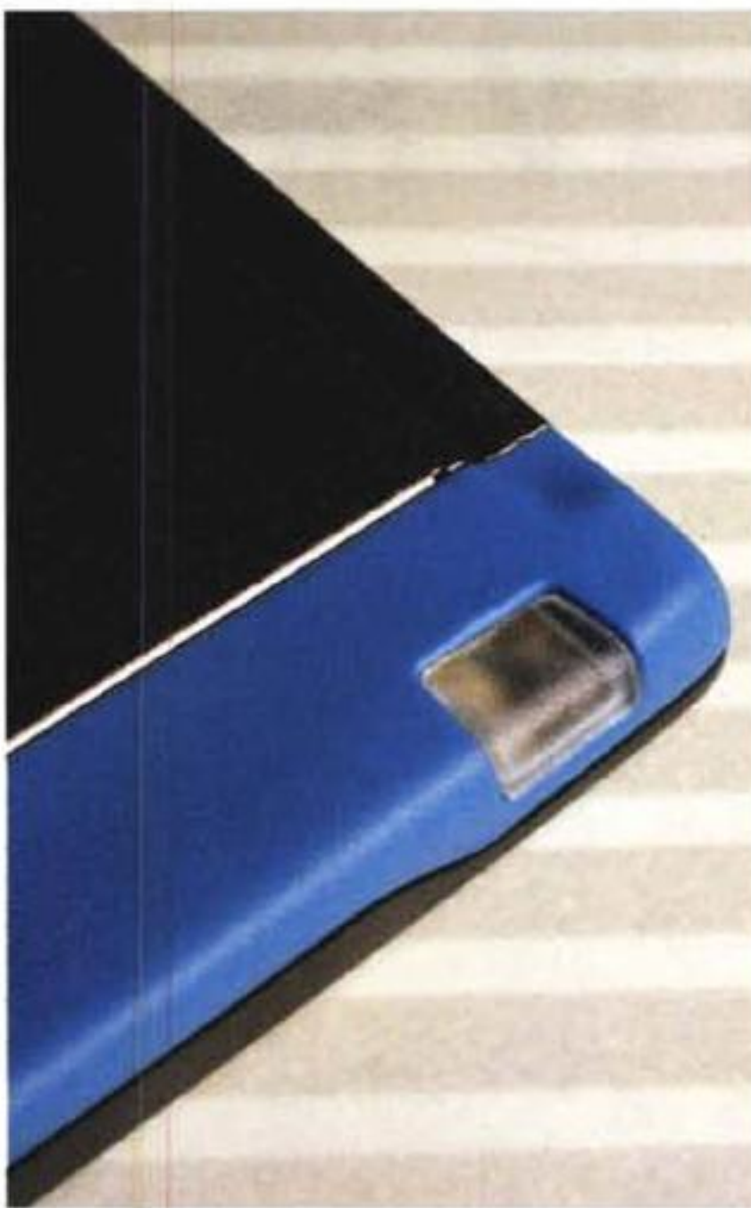
Particolare dei LED, indicanti lo stato operativo del dispositivo e la velocità di trasmissione dei dati.
