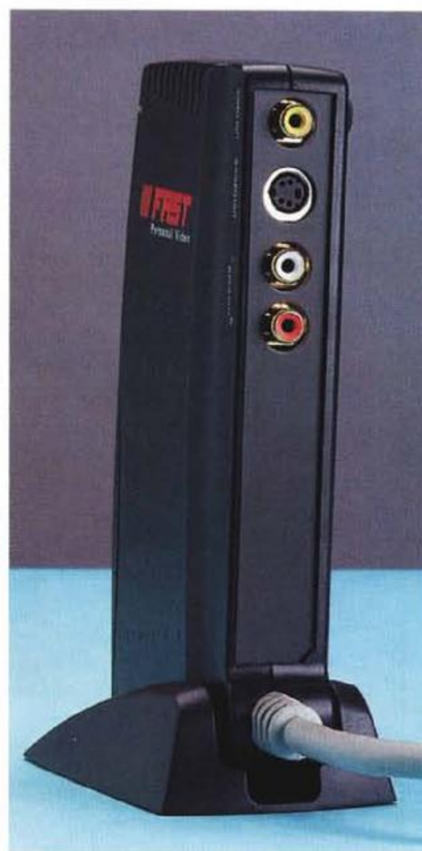
Le connessioni In/Out del Box esterno: a) vista frontale, con le connessioni audio/video d'ingresso al sistema; b) vista posteriore con le connessioni audio/video d'uscita verso periferiche analogiche (TV e VCR).
