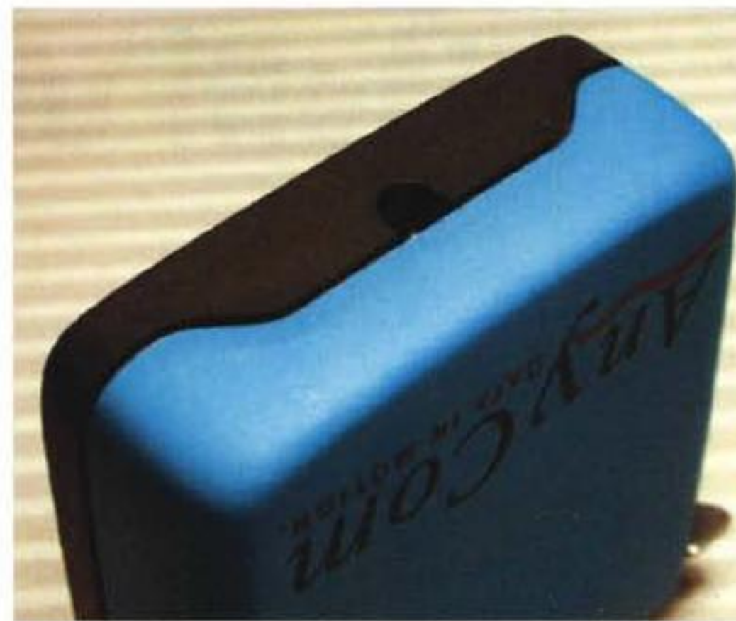
Particolare del connettore di alimentazione dell'interfaccia parallela/Bluetooth.
