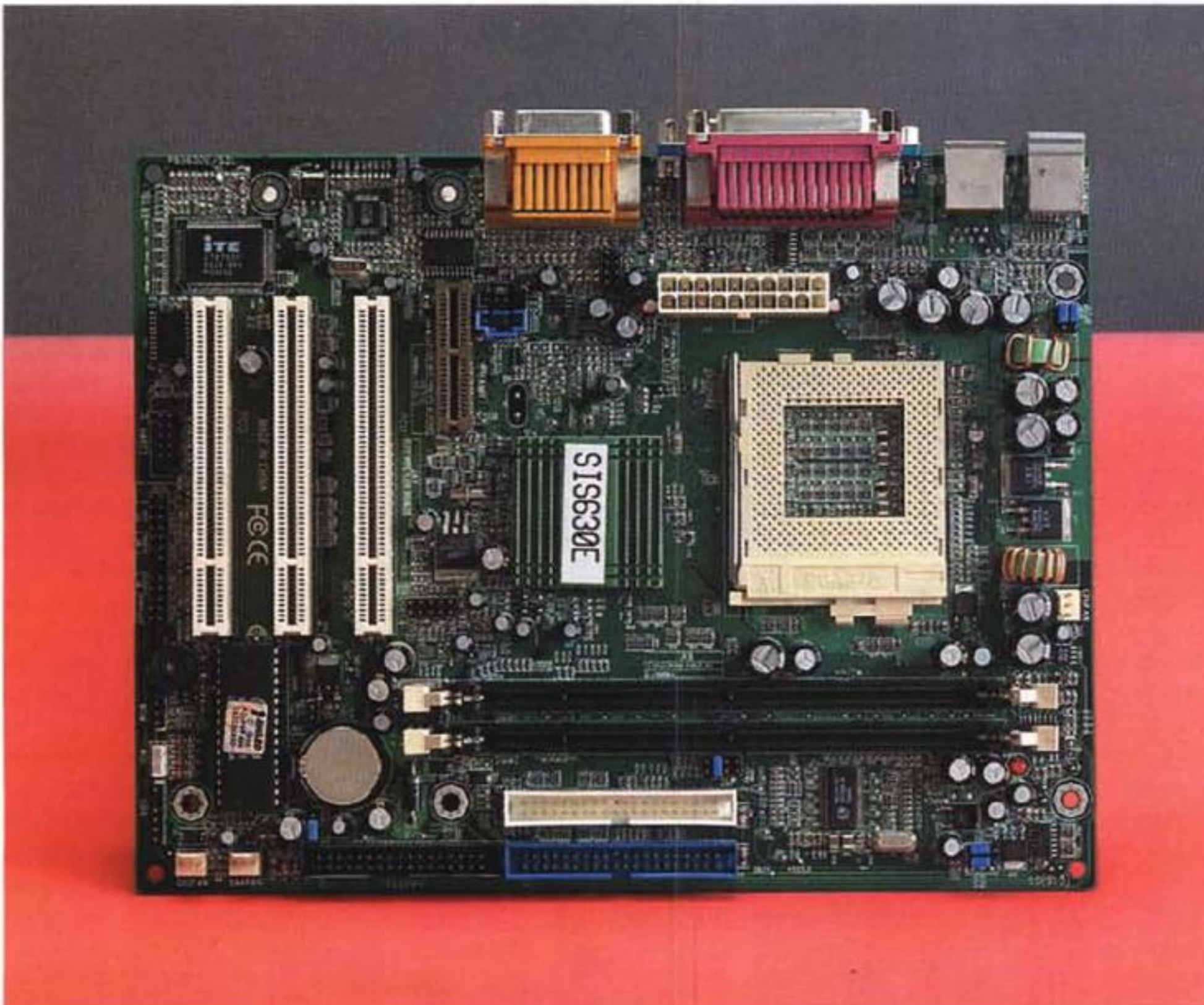
La scheda madre: da notare le minime dimensioni e la mancanza dello slot AGP (presente, invece, sull'alternativa QDI Synactix basata su chipset 815). È dotata di tre slot PCI, due slot DIMM e uno slot AMR.
