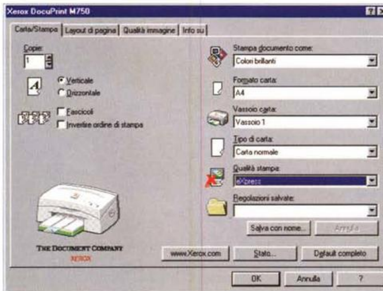
Figura 2 Tutti i principali parametri di stampa sono selezionabili da questa finestra. Tutto è molto semplice e alla portata dell'utente meno tecnico. La qualità di stampa è impostabile su quattro livelli: bozza, eXpress, normale ed elevata per carta normale. Cambiando tipo di originale cambiano le modalità di stampa possibili, ad esempio con la carta fotografica non è possibile stampare in modalità bozza e eXpress (il che effettivamente non avrebbe senso alcuno).
