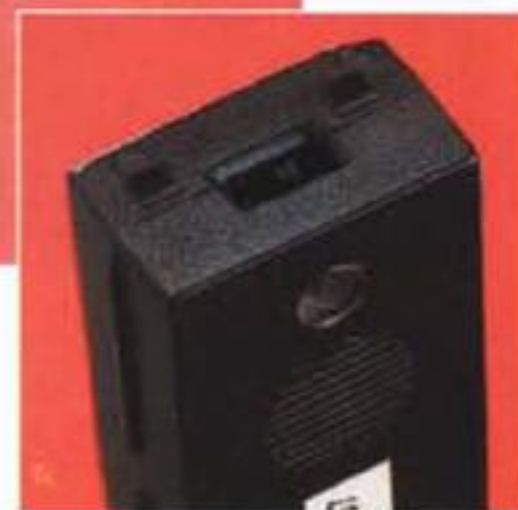
Particolare dell'interruttore a slitta di protezione dalla scrittura del dispositivo.
