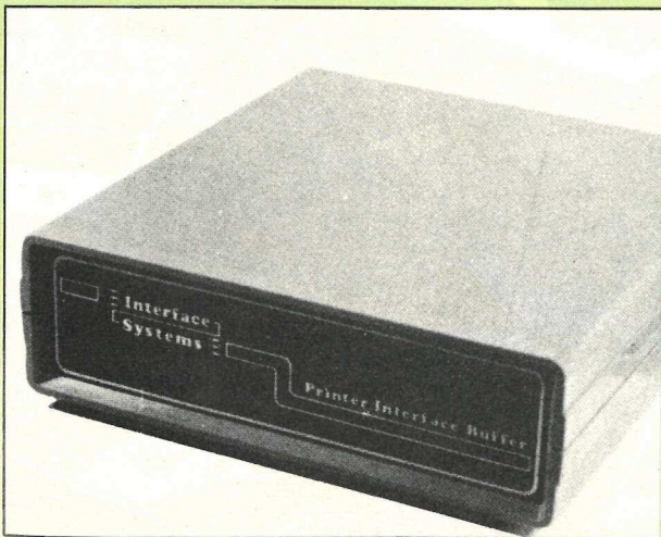
Il buffer di accumulazione per la stampante che "libera" immediatamente il computer.
