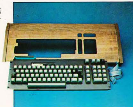
Foto 5 - Il piano della tastiera, nella versione definitiva, è di legno.
