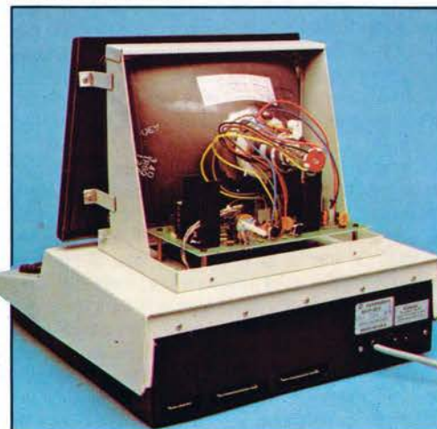
Sopra: un primo piano della piastra madre. Notare a sinistra la fila delle RAM, a destra le cinque ROM e i due zoccoli (bianchi) liberi. Il microprocessore 6502 è verso il fondo uno dei cinque grossi integrati (quello al centro). Sotto: bastano due viti per togliere la «carrozzeria» al monitor da 12 pollici.
