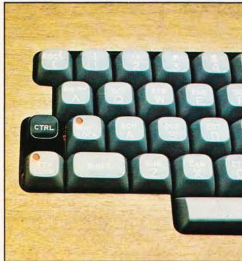
Foto 2 - La tastiera è di buona qualità e comprende il TTY LOCK, lo SHIFT LOCK, i tasti di indirizzamento cursore e il tastierino numerico.
