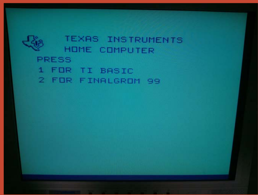
Il menu iniziale dopo un reset della FinalGROM99, si noti la scelta della stessa in opzione 2.
