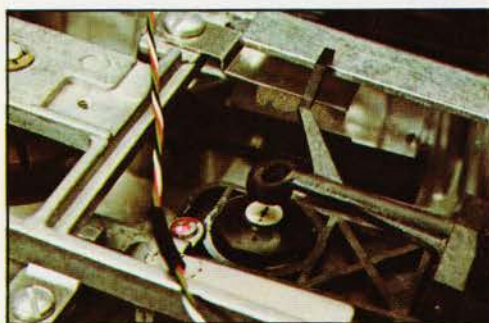
L'unità Dual Floppy 2040 comprende due mini floppy Shugart 390 a doppia densità: 170 K Byte ciascuno. Qui a fianco si vedono due particolari della meccanica: la foto a destra mostra la testina di lettura, che può spostarsi in direzione radiale rispetto al disco per la lettura delle varie tracce.
