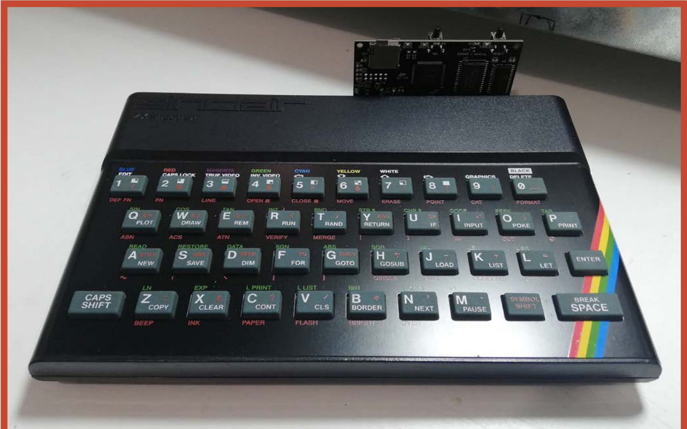
In questa foto potete vedere come si presenta uno Spectrum 48K con l'interfaccia DIVmmc collegata e pronta all'uso. Notare la compattezza e robustezza dell'insieme.
