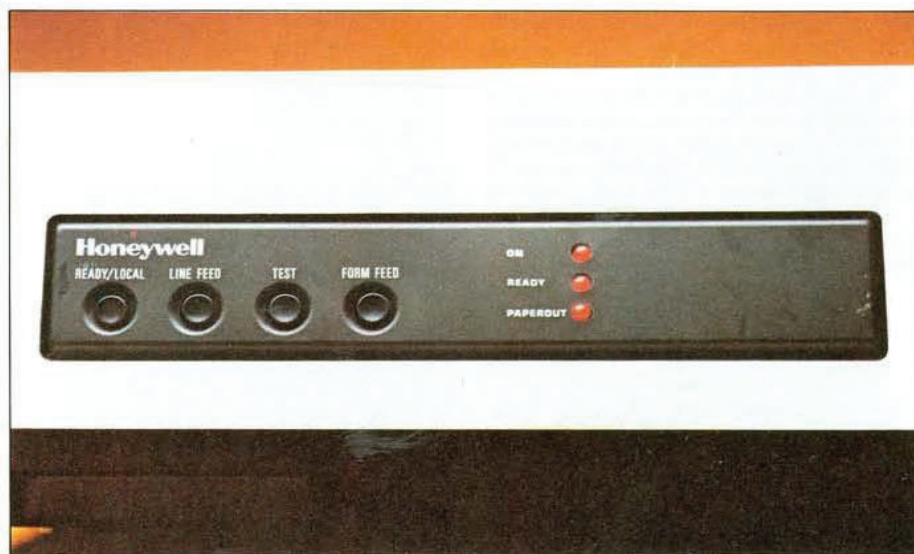
Il pannello sul frontale comprende quattro pulsanti e tre spie.
