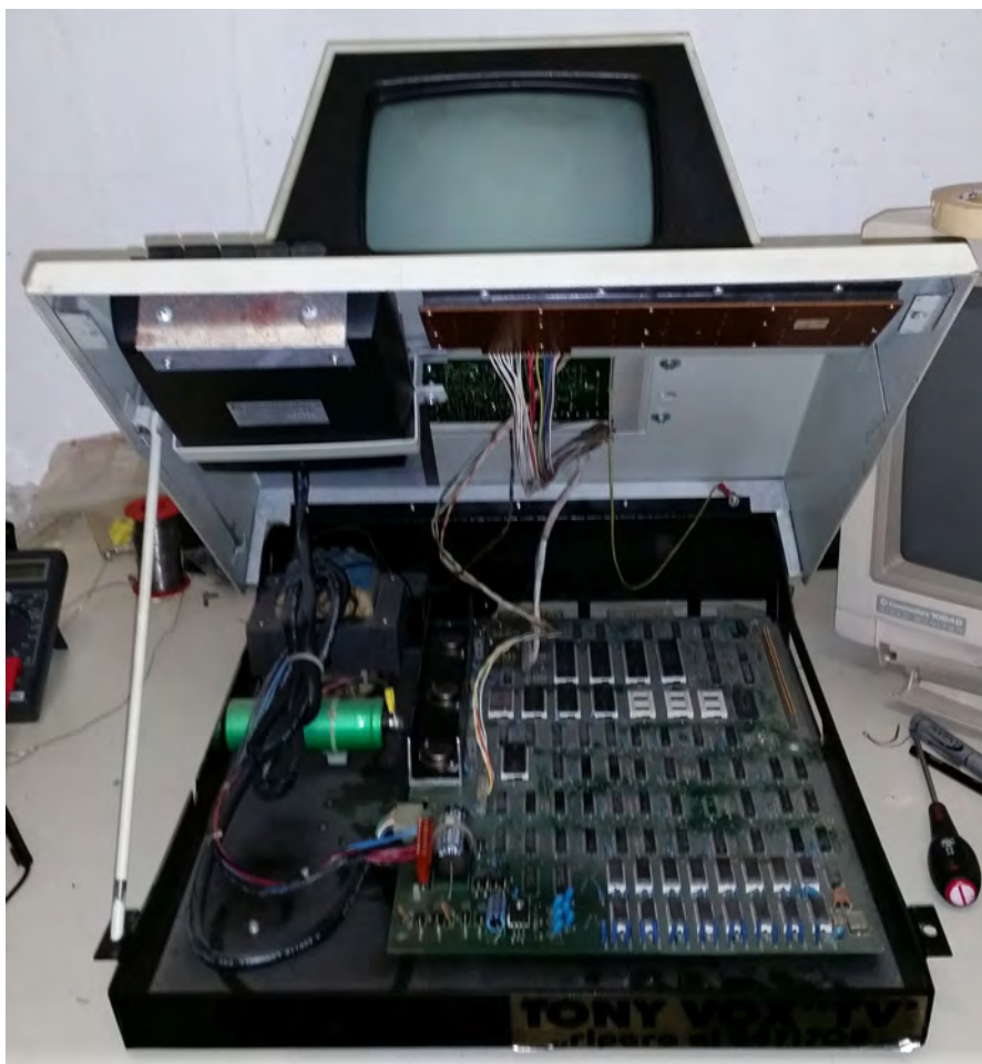
Il PET si apre proprio come il cofano di un'automobile.
