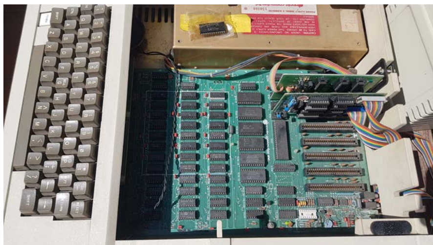
A sinistra, la scheda con l'alimentatore nel contenitore. Sopra, i condensatori RIFA.
