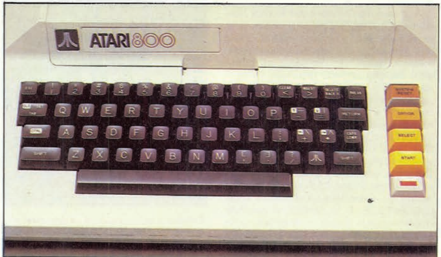
Sulla destra della tastiera (standard ASCII) si trovano la spia di accensione e quattro grossi tasti SYSTEM RESET, OPTION, SELECT e START.
