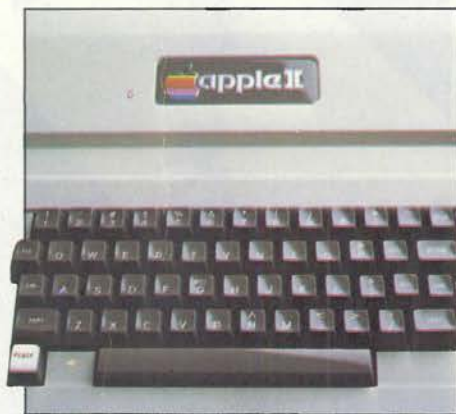
Sulla tastiera, in basso a sinistra c'è la spia di accensione; in alto a destra il (comodo) tasto REPT (repeat) e il (pericoloso) RESET.
