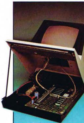
Qui sotto, una vista di insieme dell'8032 aperto. Il board è fissato alla base, la tastiera al coperchio del contenitore, incernierato posteriormente.
