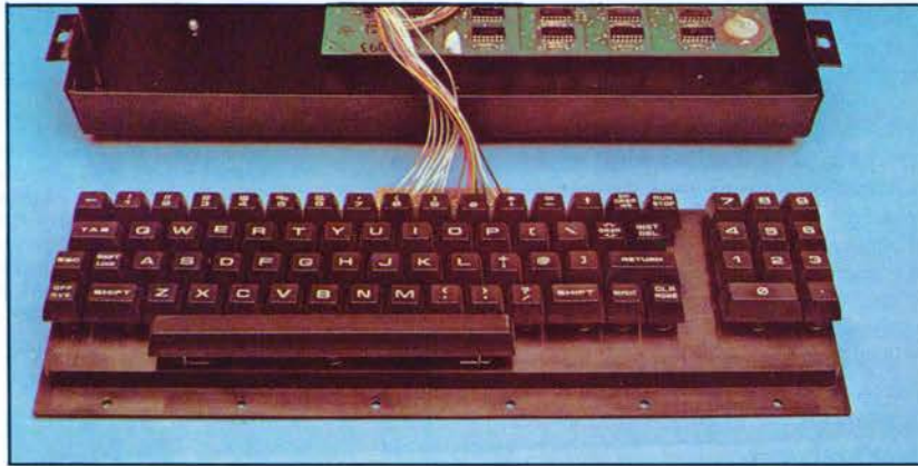
Sopra: una vista della tastiera, che è fissata al coperchio del contenitore. Sotto: un particolare dell'avvisatore acustico, sullo spigolo anteriore destro del board.
