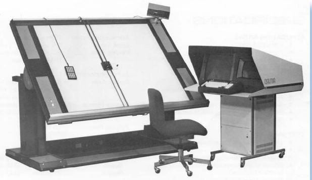
Fig. 2 – Prodotti perfettamente industrializzati e integrati sono disponibili sul mercato dagli anni '70. Nella foto una stazione CALMA dopo la metà degli anni '70 con un "digitizer" per l'inserimento delle informazioni grafiche costituito da un tavolo di lavoro (una sorta di tecnigrafo) dotato di sistemi per individuare con precisione le coordinate dei punti del disegno.
