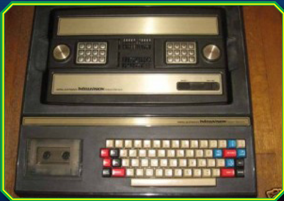
6. Tastiera e registratore a cassette per l'Intellivision che trasforma la console Mattel in un vero Micro Computer.
