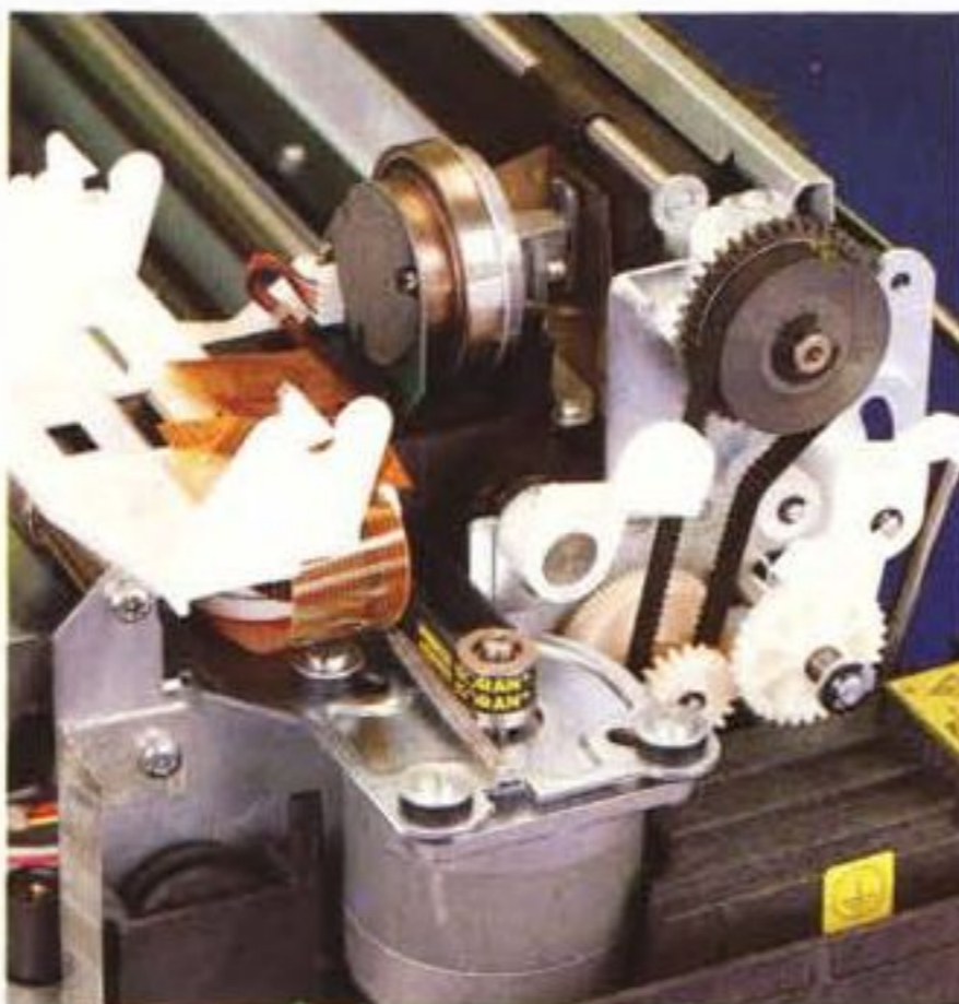
Un particolare della testa di stampa «Energy Stored» e del generoso motore che comanda i movimenti della testa di stampa.
