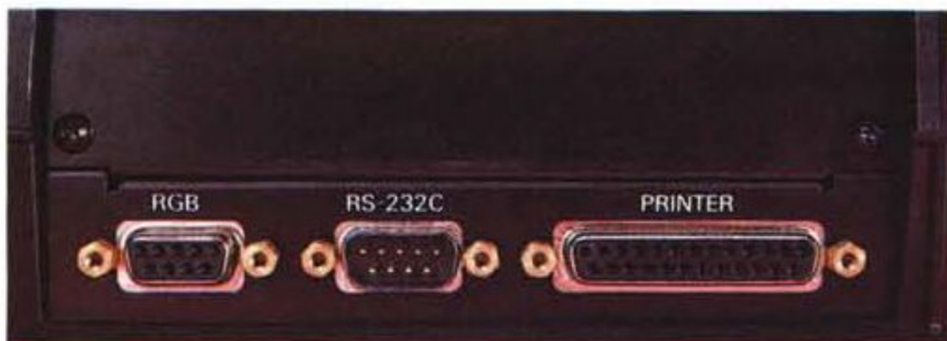
Le connessioni esterne: monitor RGBI, interfaccia seriale, interfaccia parallela.
