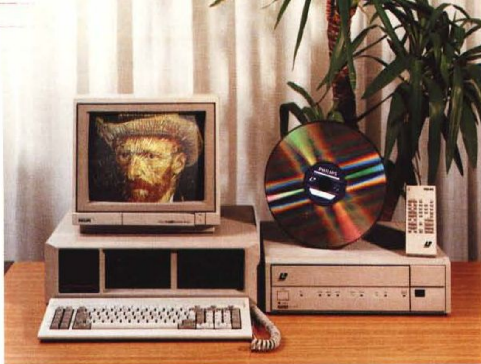
Il sistema per videodischi interattivi Philips consente la gestione di un lettore LaserVision con computer MS-DOS.
