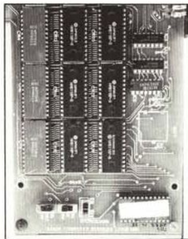
Questa foto riproduce la porzione della scheda di espansione RAM della STACK su cui è alloggiata la EPROM denominata VIC KIT II. Sotto un esempio di grafica con il VIC KIT II.
