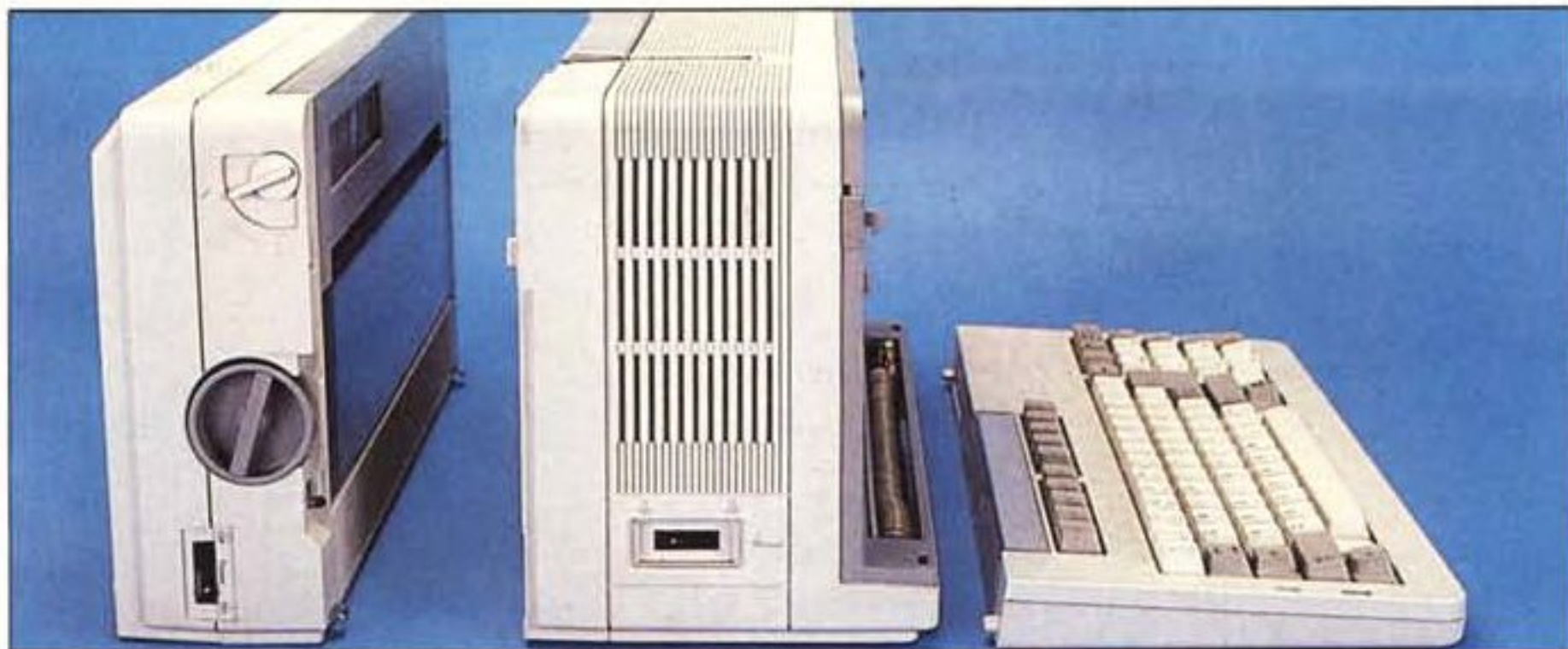
La trasformazione del PC-7000 da... valigia a computer. Le tre unità si agganciano a formare un corpo unico molto compatto.
