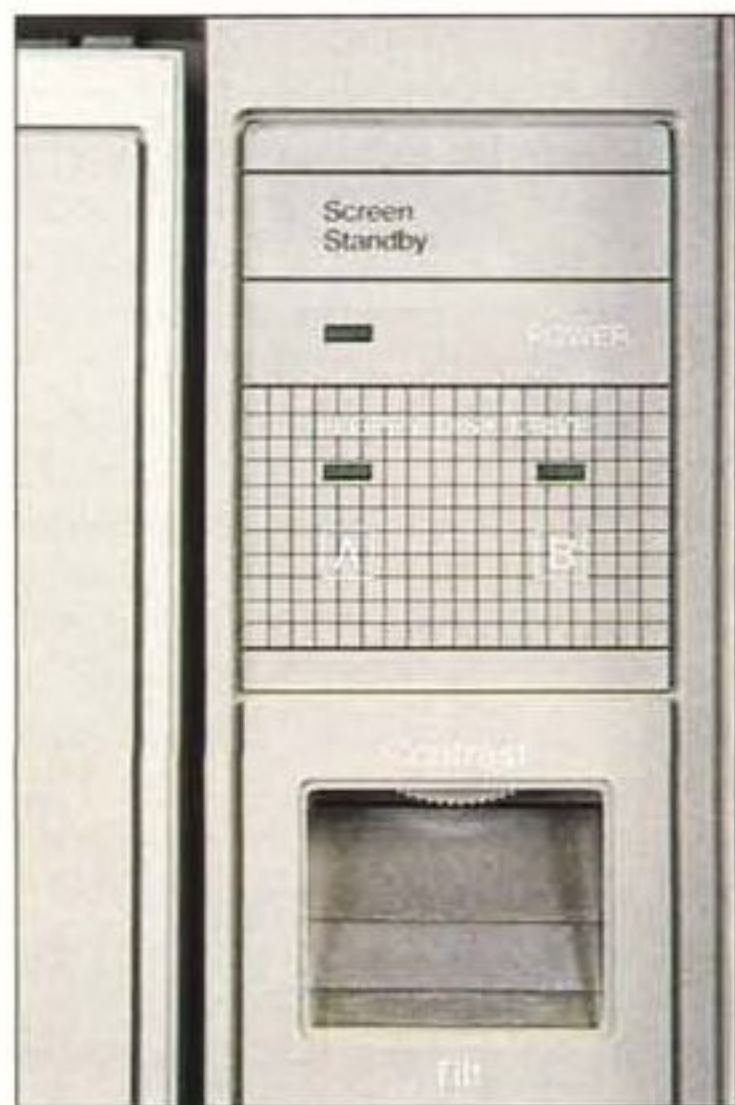
Due particolari del pannello frontale. A sinistra il pannello con le spie ed i controlli dello schermo. A destra il modo in cui si sgancia il display per inclinarlo.
