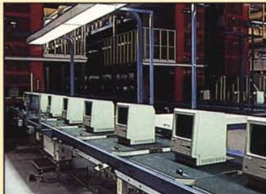
Abbiamo avuto la possibilità di visitare gli stabilimenti di Fremont, la fabbrica costruita apposta per Mac vicino a Cupertino. Il livello di automazione è molto spinto, dalla raccolta dei componenti all'inserzione nel circuito stampato, fino all'imballaggio e all'accatastamento su pallet con successiva chellophanatura. (Le due foto dell'interno dello stabilimento sono state fornite dalla Apple).
