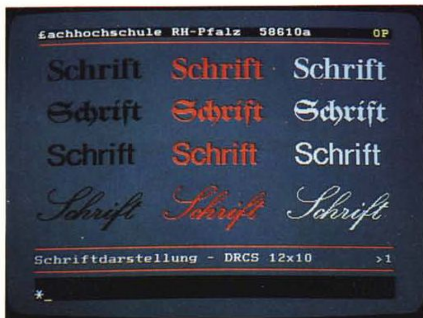
Esempio di grafica ad alta risoluzione ottenuta con lo standard CEPT. L'immagine è tratta dal Bildschirmtext, il videotex tedesco.
