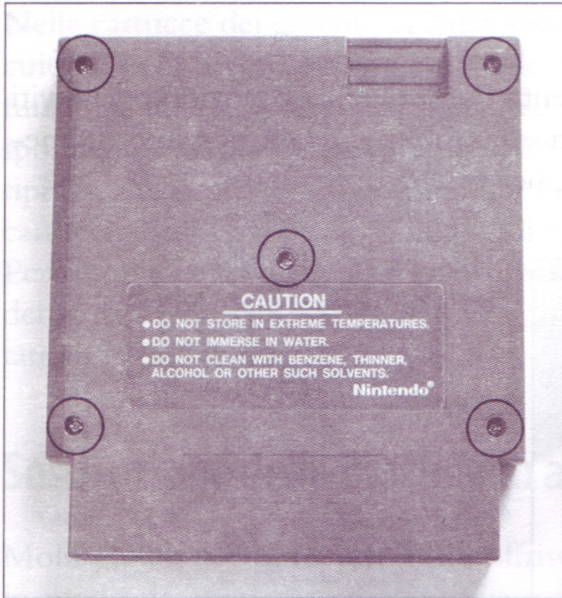
Figura 6.33 Retro di una cartuccia di giochi per NES, versione a cinque viti.
