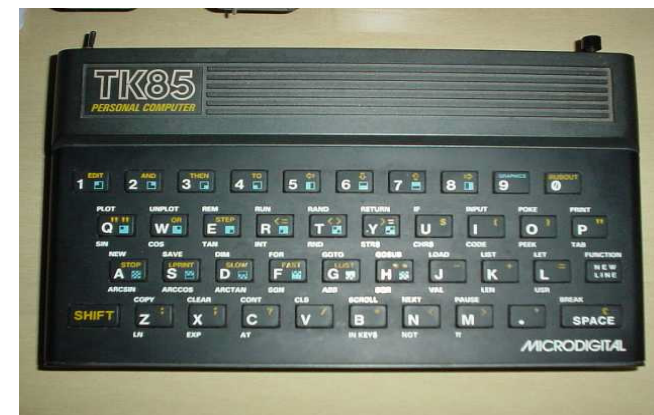
Fig. 10 - Il TK85, compatibile con il Sinclair Z81.
