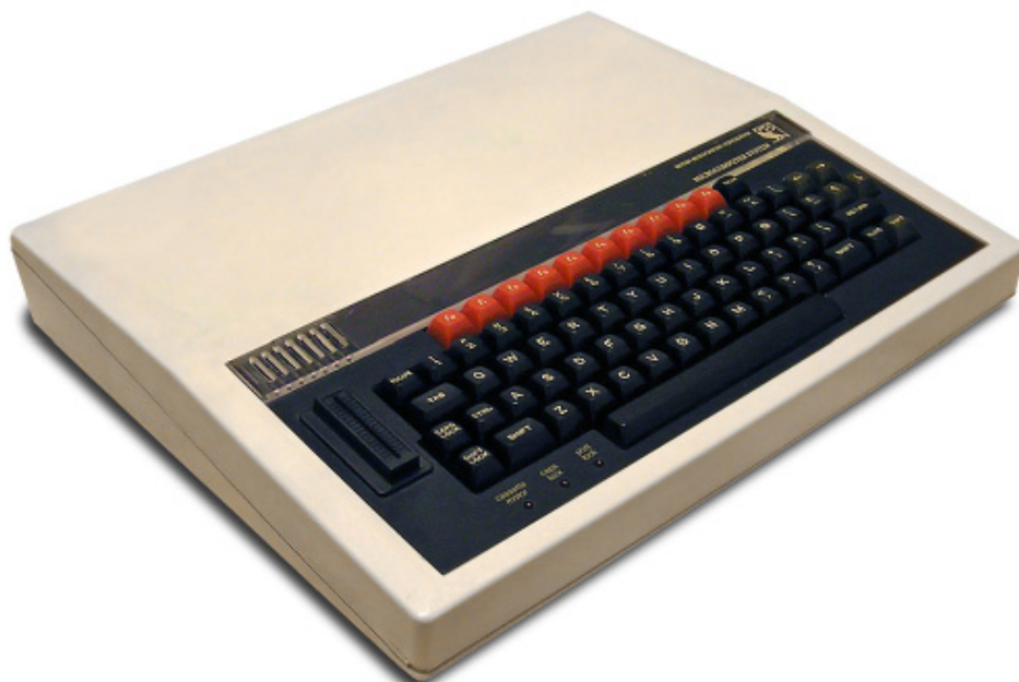
Fig. 4 - Modello B, con lo slot di espansione inserito a sinistra della tastiera.
