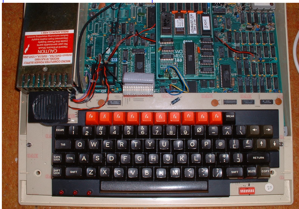
Fig. 10 - Il sistema aperto mostra la disposizione dei macro-elementi: tastiera, piastra madre; a sinistra in alto l'alimentatore con vicino lo speaker.
