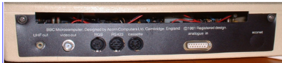
Fig. 7 - Il retro; da sinistra: uscita TV, uscita monitor monocromatico, per monitor a colori, la RS423, l'uscita registratore, l'ingresso analogico e il posto per la porta rete Econet.
