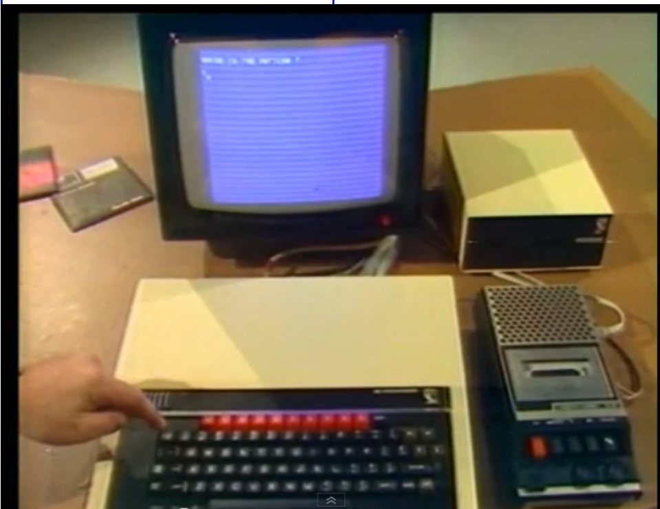
Fig. 11 - Il sistema funzionante completato con registratore a cassette e floppy disk. (Immagine tratta dal programma della BBC).
